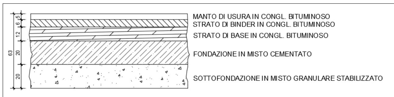
FIGURA 36 – PAVIMENTAZIONE PREVISTA PER LE ROTATORIE SULL'ASSE PRINCIPALE ED I RELATIVI RAMI
