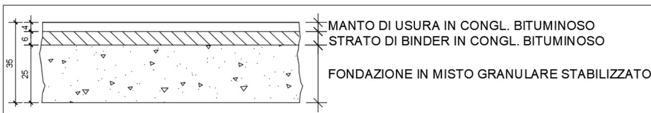
FIGURA 38 – PAVIMENTAZIONE PREVISTA PER LA VIABILITÀ INTERPODERALE
