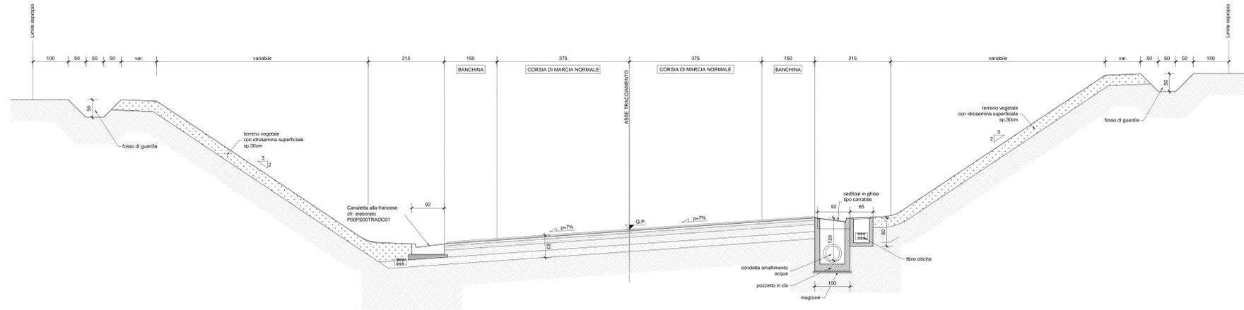
SEZIONE TIPO IN CURVA IN RILEVATO CON BARRIERA FONOASSORBENTE - WBS DA - DA PK 1+871,84 A 2+170,00 ,DA PK 2+995,05 A 3+104,00 , DA PK 3+345,35 A 3+480,00,
