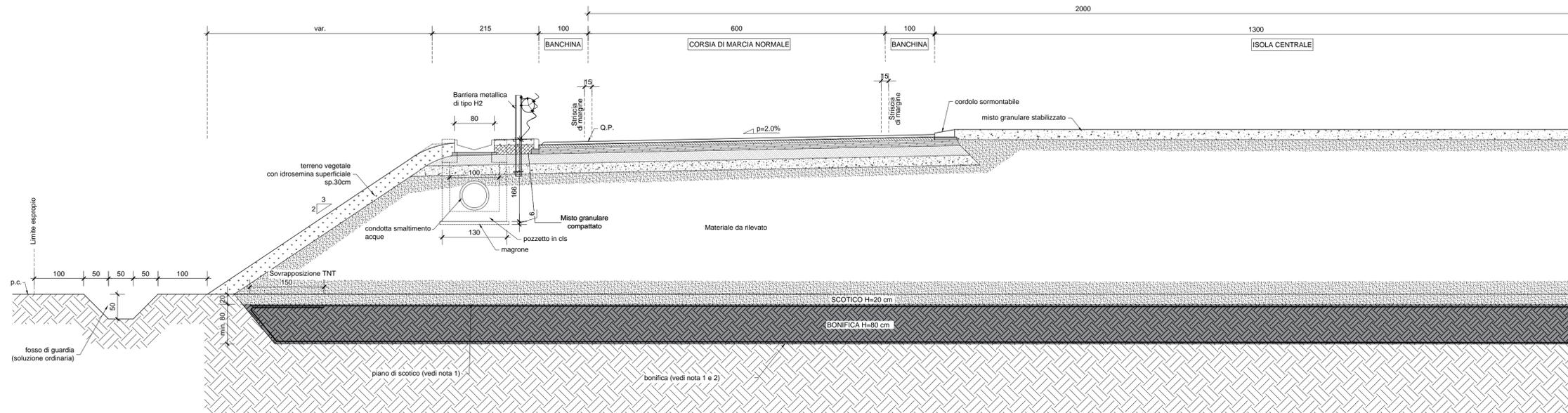
SEZIONE TIPO IN TRINCEA ROTATORIA DI RAGGIO 20 m - "ROTATORIA DI CAMPONE" - WBS DB-4
