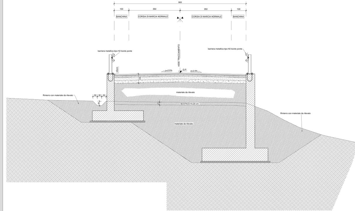
SEZIONE TIPO IN TRINCEA CON MURO IN SX DELLA "RICUCITURA EX SS38 - ELIPORTO" - DC-10 E SEZIONE TIPO F1 - DM 05/11/2001 DELLA "RICUCITURA ELIPORTO"- DC-10
