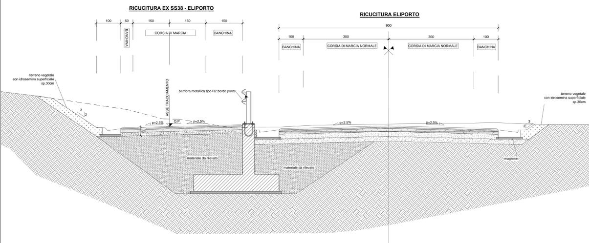
SEZIONE TIPO DELLA "RAMPA DI ACCESSO PRIVATA" - DC-10 E SEZIONE TIPO F1 - DM 05/11/2001 DELLA "RICUCITURA ELIPORTO"- DC-10
