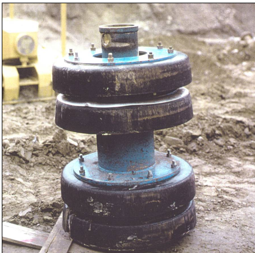
Fig. 5.2/A: Pig convenzionale impiegato nelle operazioni di collaudo idraulico e di pulizia della condotta.
