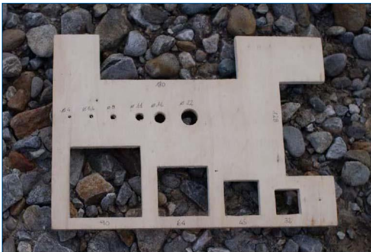
Figura 6.2 - calibro in legno utilizzato per l'analisi granulometrica
