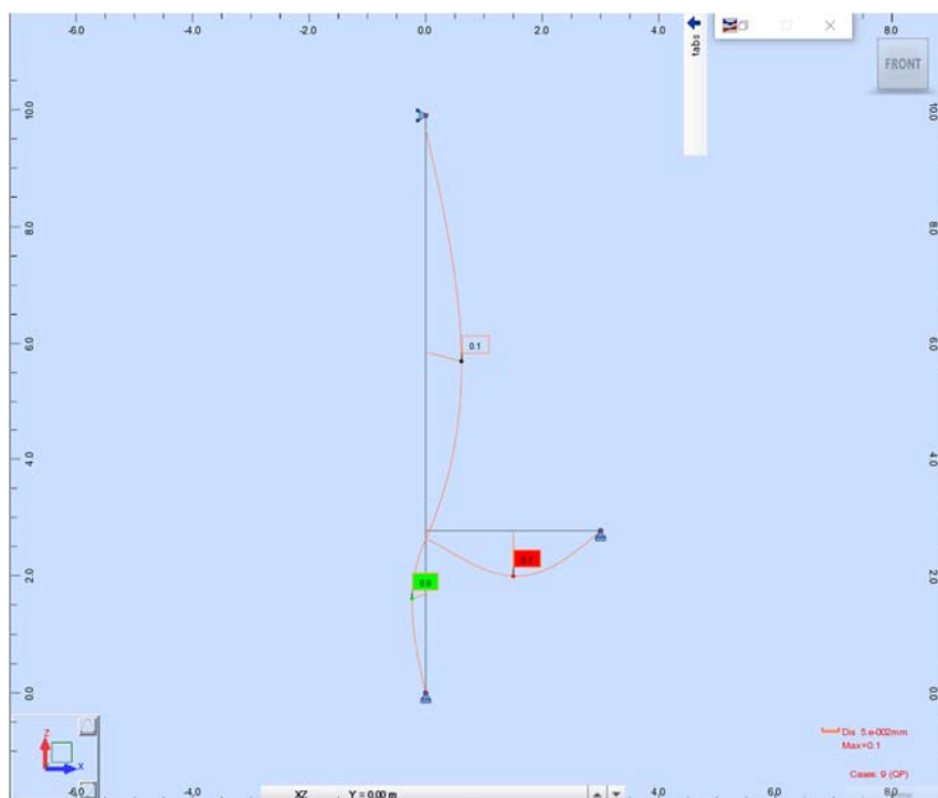
FIGURA 23: DEFOTMATA COMBINAZIONE SLE QUASI-PERMANENTE
