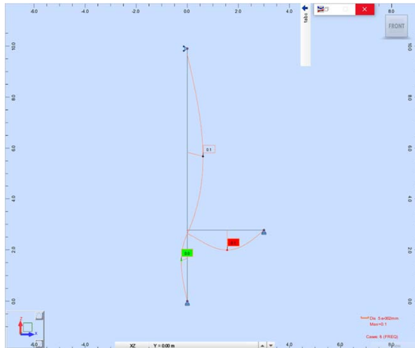
FIGURA 22: DEFOTMATA COMBINAZIONE SLE FREQUENTE
