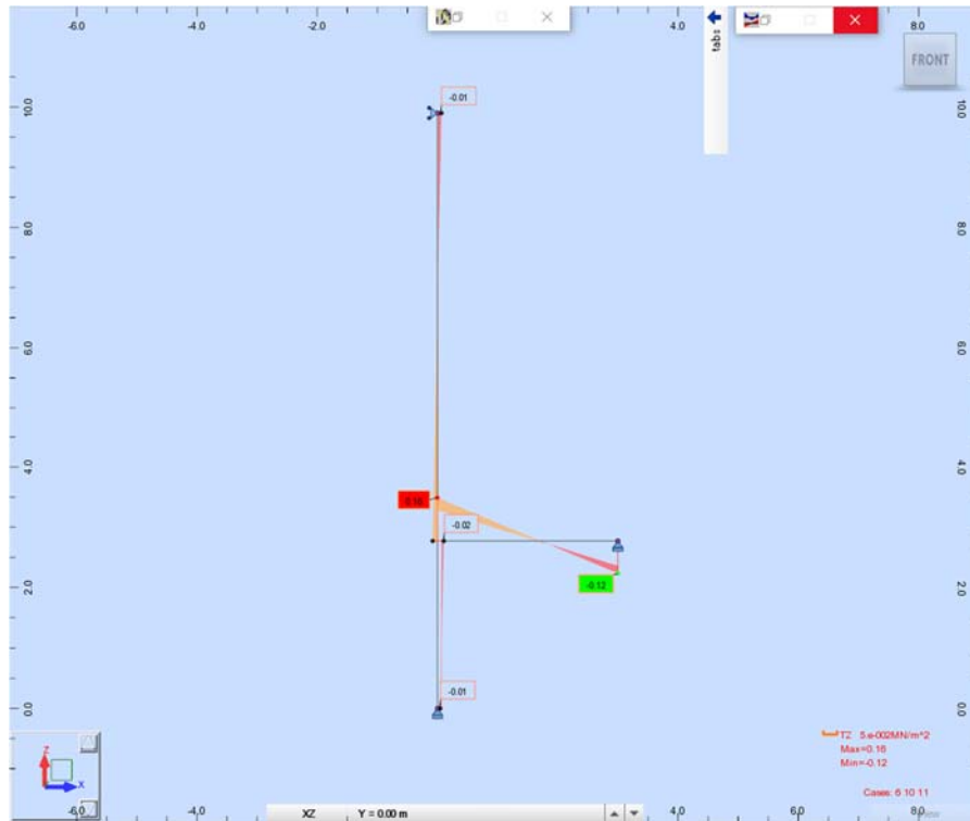
FIGURA 21: TENSIONE DI TAGLIO T
