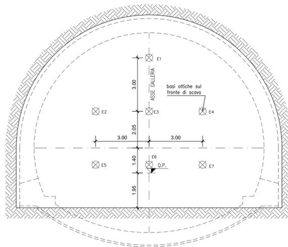
**MISURA DELL'ESTRUSIONE DEL FRONTE CON SISTEMA DI 7 BASI OTTICHE INSTALLATE SUL FRONTE DI SCAVO:**
