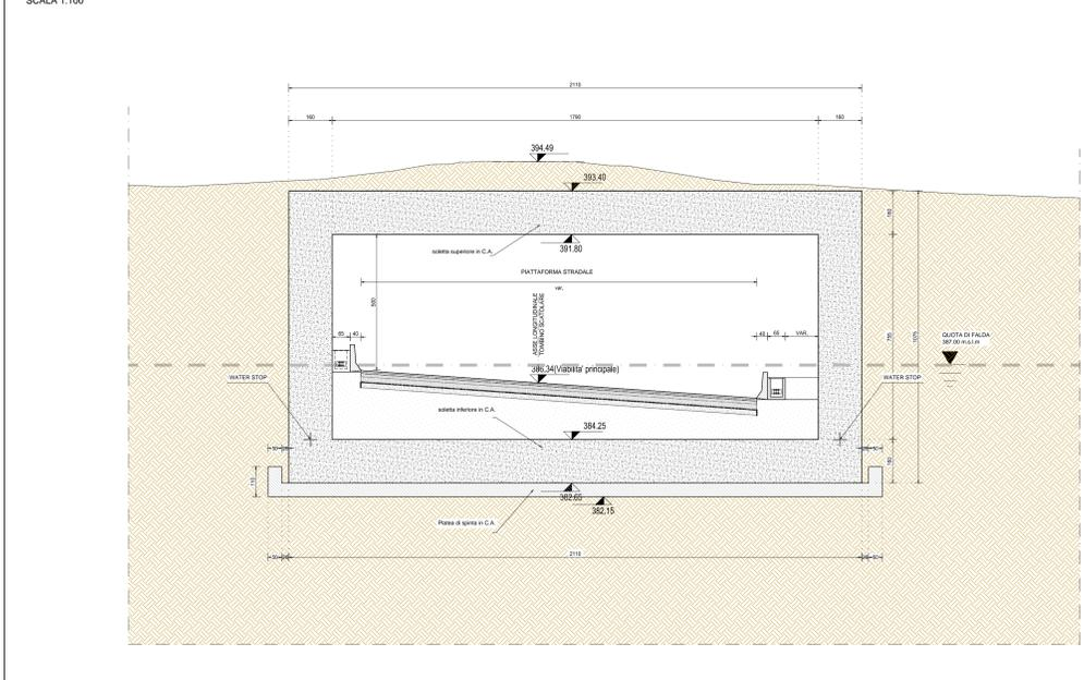
SEZIONE LONGITUDINALE DI MONOLITE VARATO
