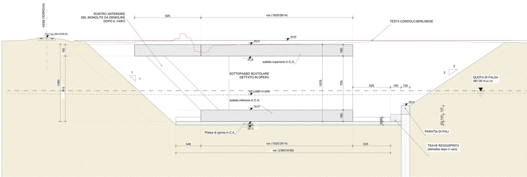
SEZIONE TRASVERSALE MONOLITE PRIMA DELLA SPINTA
