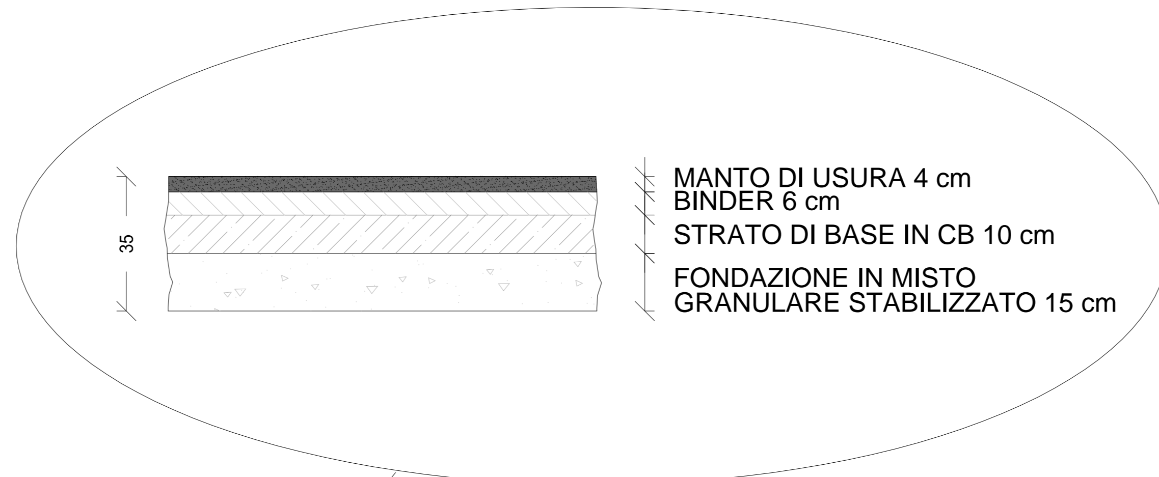
PARTICOLARE PAVIMENTAZIONE STRADALE scala 1:10
