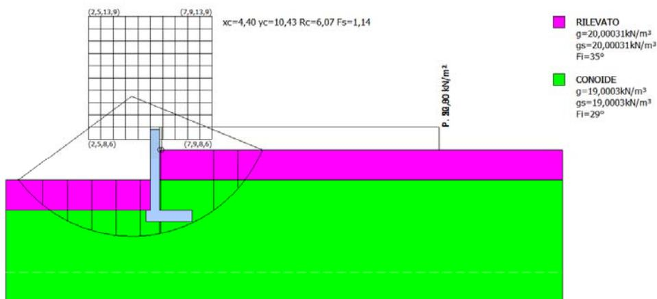
Fig. 7b Modello di calcolo per analisi di stabilità
