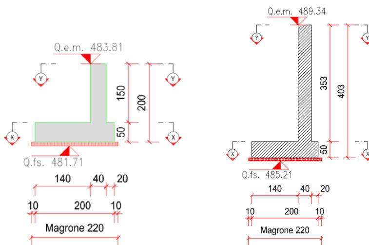
Fig. 2 Sezione trasversale conci n. 1 e n. 4
