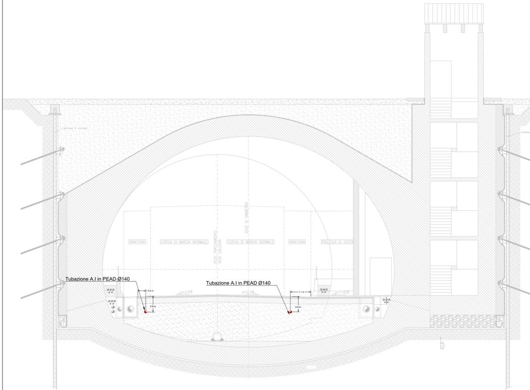
SEZIONE TIPO ARTIFICIALE CORRENTE - SCALA 1:100
