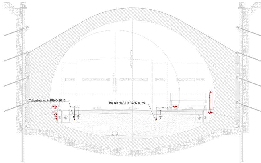
SEZIONE TIPO ARTIFICIALE USCITA DI SICUREZZA - SCALA 1:100
