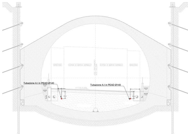
SEZIONE TIPO ARTIFICIALE CORRENTE NICCHIA - SCALA 1:100
