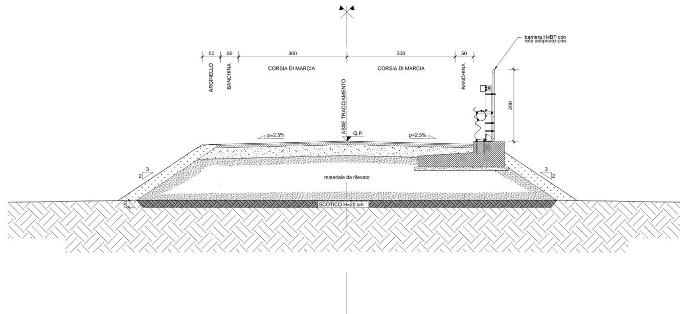
SEZIONE TIPO ROTATORIA CON DIAMETRO 32 m
