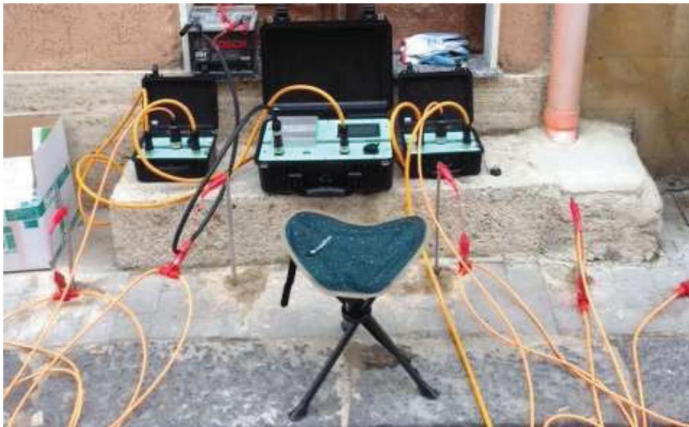
La frequenza di iniezione di corrente è stata impostata pari a 28.5 Hz, che ha consentito di effettuare le misure con una ripetibilità media pari al 4%, in un tempo in un tempo di acquisizione di circa 120 minuti per il dataset completo avente 2632 misure.
