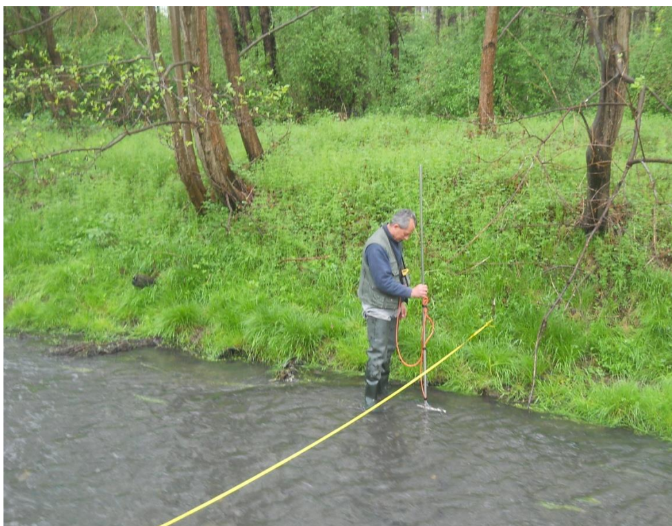
Foto 3 - Misura di portata con mulinello ordinario sul rio Ribes.
