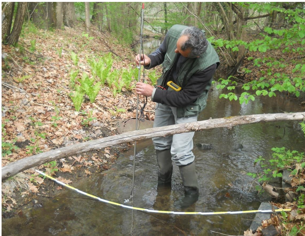
Foto 2 - Misura di portata con micromulinello sulla Borra della Massa.
