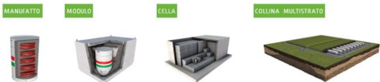
Figura 3.3-6: Le barriere ingegneristiche del Deposito Nazionale
