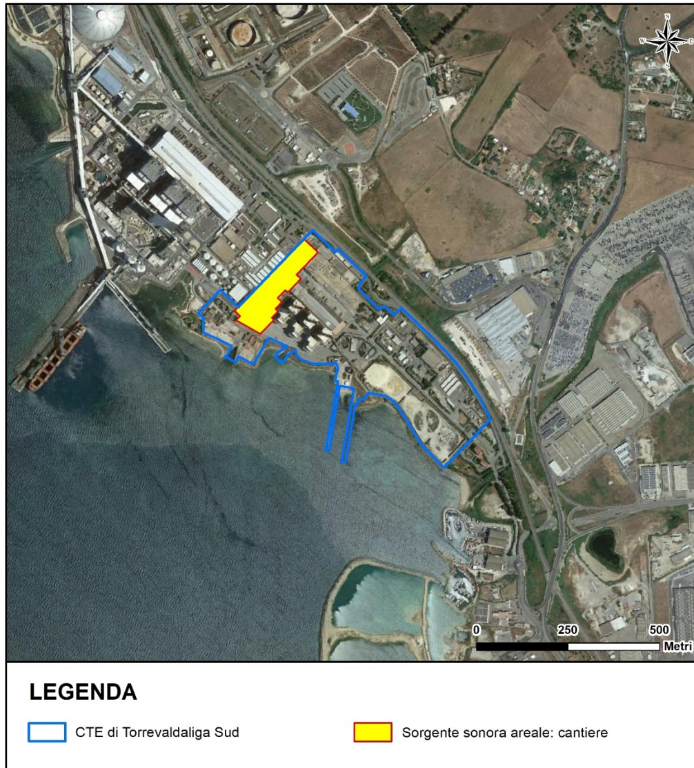
Figura 5.2.1a Ubicazione della sorgente sonora areale con cui è stata schematizzata l'area di cantiere di TV7
