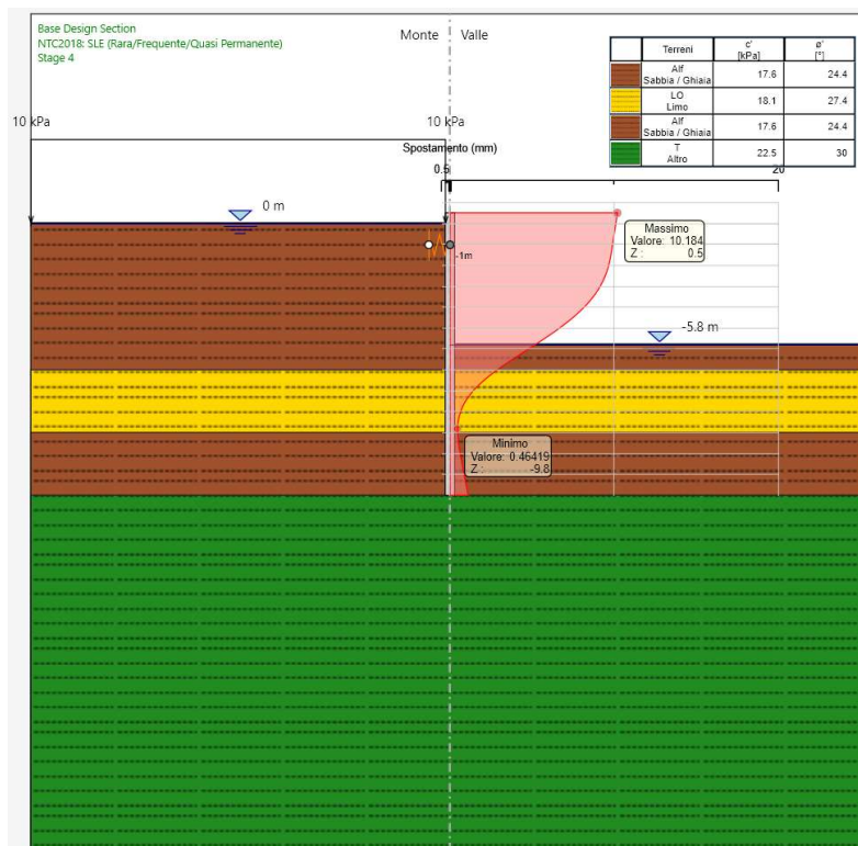
Figura 9.5 Diagramma degli spostamenti agli SLE
