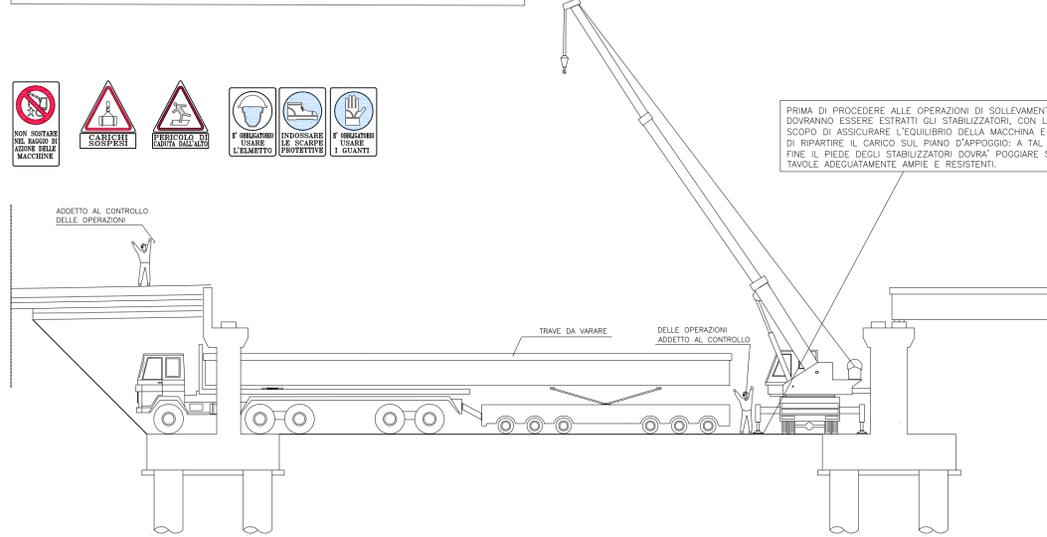
PRIMA DI PROCEDERE ALLE OPERAZIONI DI SOLLEVAMENTO, DOVRANNO ESSERE ESTRATTI GLI STABILIZZATORI, CON LO SCOPO DI ASSICURARE L'EQUILIBRIO DELLA MACCHINA E DI RIPARTIRE IL CARICO SUL PIANO D'APPoggio: A TAL FINE IL PIEDE DEGLI STABILIZZATORI DOVRÀ POGGIARE SU TAVOLE ADEGUATAMENTE AMPIE E RESISTENTI.
