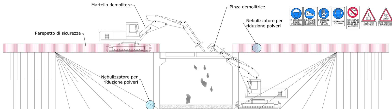
Fase 3: Demolizione impalcato con escavatore con martello demolitore e pinza
