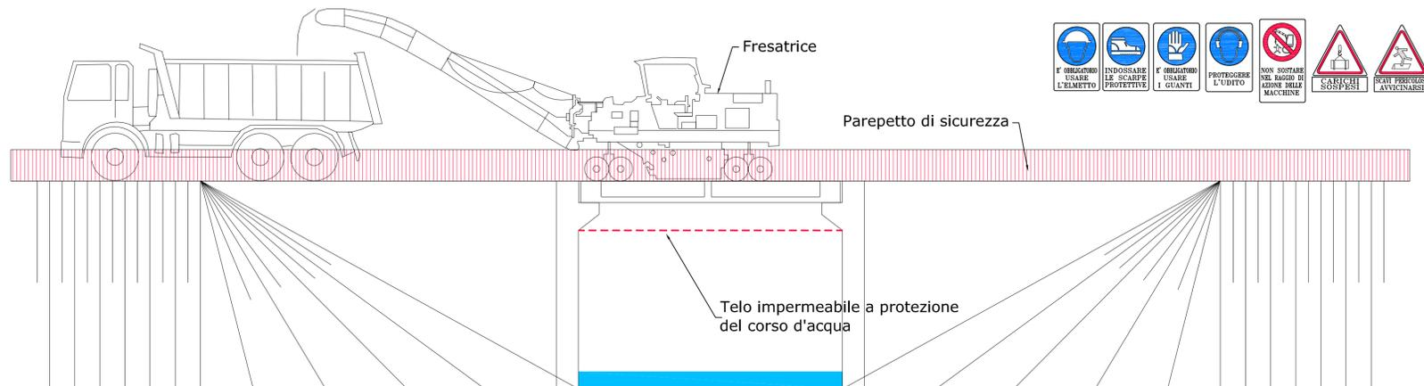
Fase 2: Montaggio di telo impermeabile sotto l'impalcato
