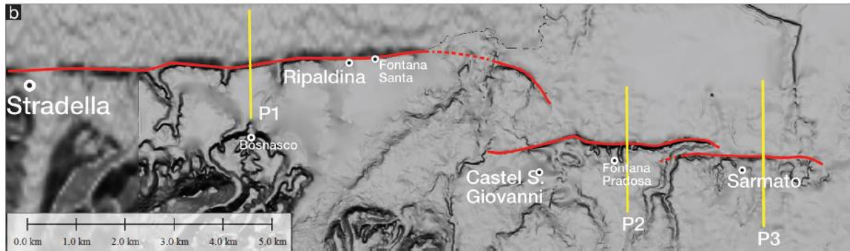
Figura 4.3.5: DEM (risoluzione di 5 m) dell'area compresa tra Voghera, Piacenza e Lodi con evidenziate le principali strutture attive; P1, P2 e P3 sono i profili topografici di dettaglio, che evidenziano il rigetto verticale della superficie (v) causato dal thrust.
