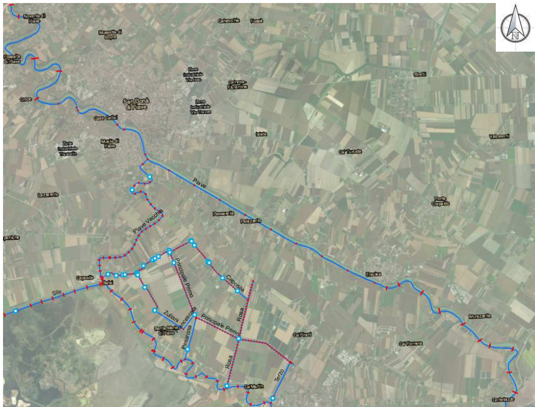
Figura 5.2 – Dominio del modello idraulico monodimensionale implementato: lungo le aste dei corsi d'acqua, in rosso sono indicate le sezioni trasversali inserite (cross-section) ed in ciano i manufatti (structures).
