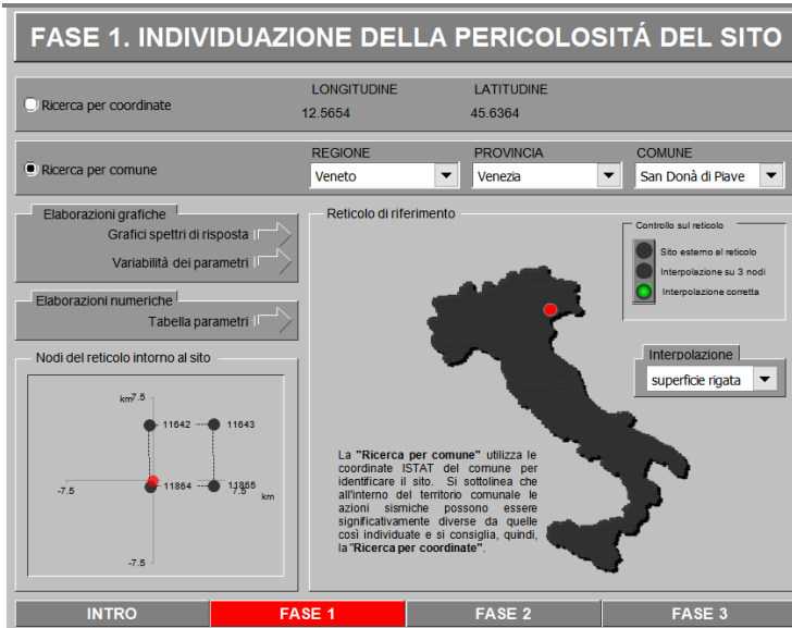
Figura 2 - Individuazione della pericolosità sismica del sito
