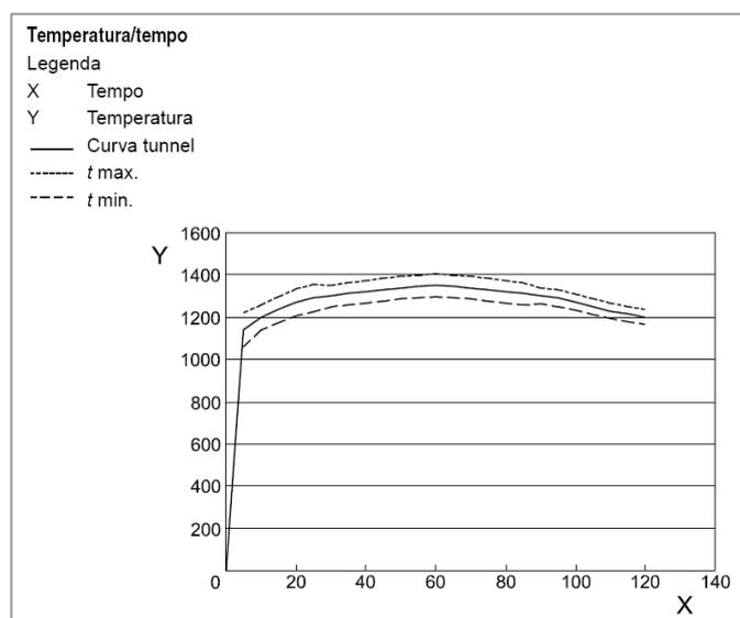
Figura 1 - Curva Temperatura/tempo “Tunnel” da UNI11076
