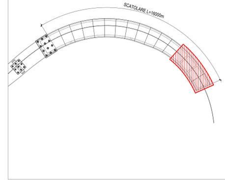
PARTICOLARE GIUNTO STRUTTURALE CORDONCINO BENTONITICO - Scala 1:10
