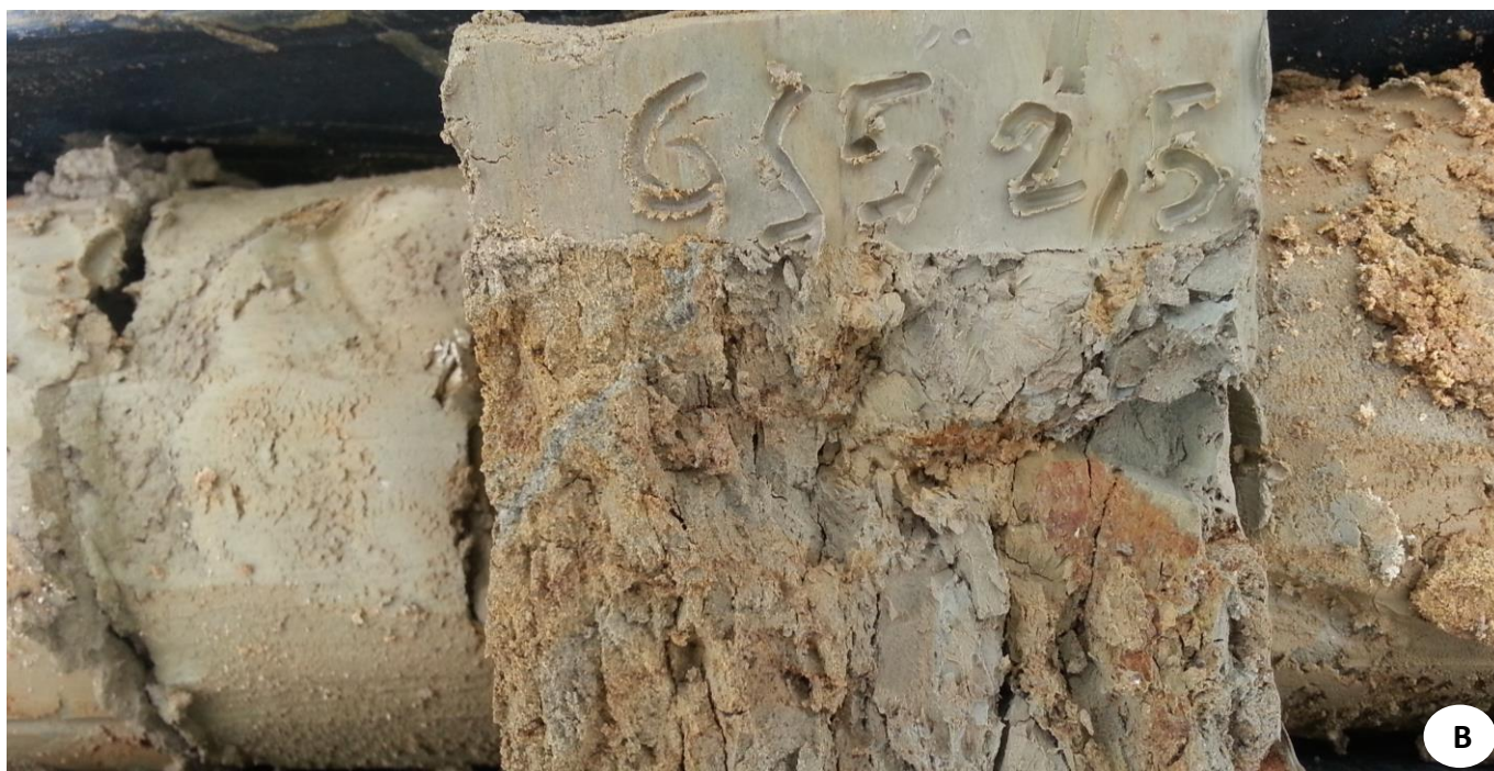
Figura 22. Deposito affiorante di eluvio-colluviale (b2) in zona industriale Dittaino (a), nella foto sottostante (b) dettaglio di una foto del sondaggio 655 del 2015.
