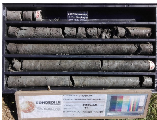
Figura 57 - Formazione del Flysch Numidico FYN3 - Foro di sondaggio 4SD25, tra 50 e 55 m da p.c. (Argilla consistente con livelli di sabbia fine)
