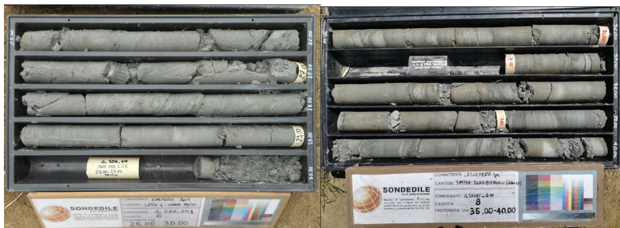
Figura 30 - Formazione Terravecchia (TRVa) – Foro di sondaggio: 4SD6 (Nuova Enna), tra 25 e 30 m da p.c (sinistra) e 4SD8 (Sicani), tra 35 e 40 m da p.c. (destra).
