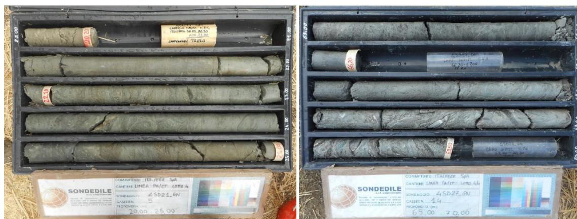
Figura 47 – Argille Varicolori Inferiori - Foro di sondaggio 4SD21 (sinistra) tra 20 e 25 m da p.c., e 4SD27 (destra) tra 65 e 70 m da p.c.
