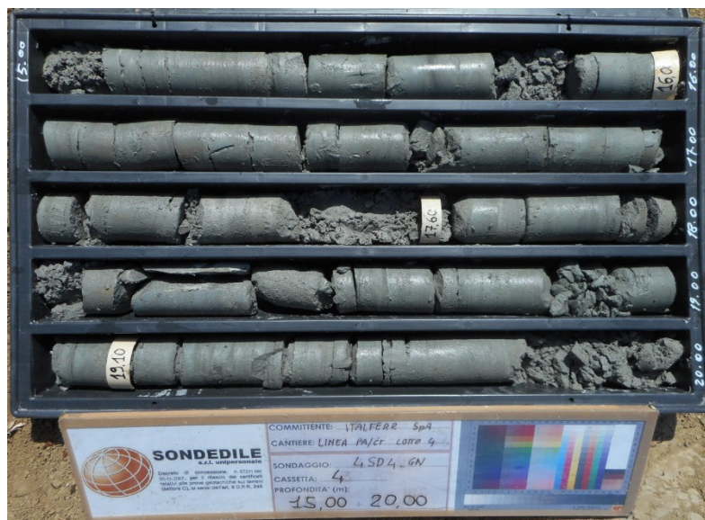
Figura 17 - Formazione Terravecchia (TRV) – Foro di sondaggio 4SD4, tra 15 e 20 m da p.c.
