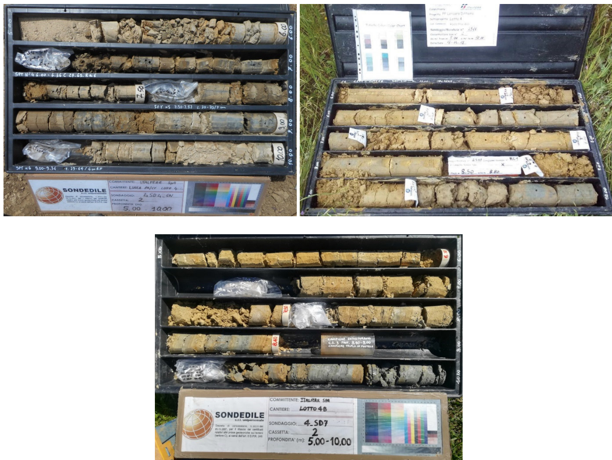
Figura 42 – Sabbie di Cozzo Campana nel foro di sondaggio 4SD4 (sinistra), 4S11 (destra) e 4SD7 (in basso) tra 5 e 10 m da p.c.
