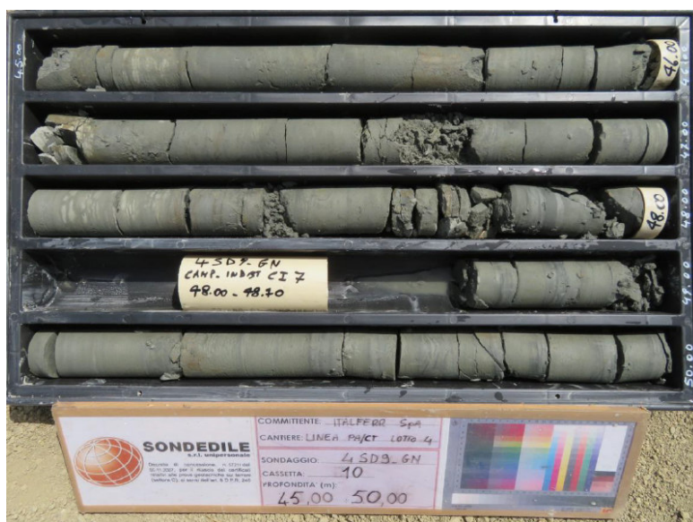
Figura 23 - Formazione Terravecchia (TRV) – Foro di sondaggio 4SD9, tra 45 e 50 m da p.c.
