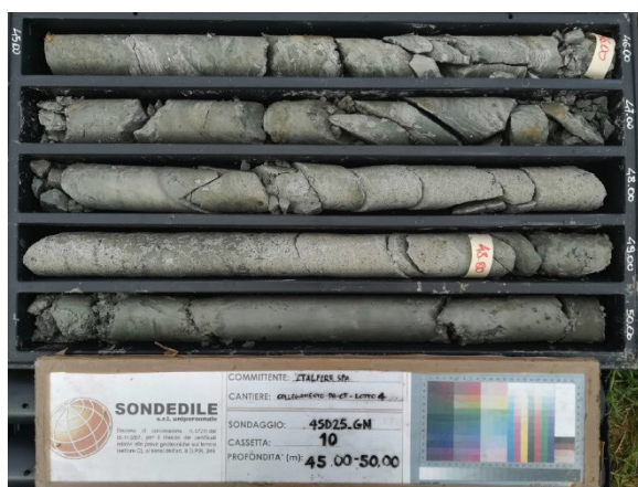
Figura 56 - Formazione del Flysch Numidico FYN3 - Foro di sondaggio 4SD25, tra 45 e 50 m da p.c. (Argilla consistente con presenza di livelli di sabbia fine e arenaria)
