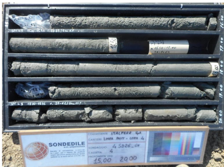
Figura 36 - Formazione Terravecchia – Litofacies TRVb - Foro di sondaggio 4SD26, tra 15 e 20 m da p.c.
