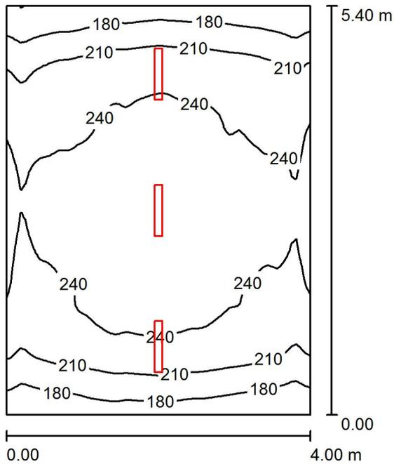
Altezza locale: 3.300 m, Altezza di montaggio: 3.000 m, Fattore di manutenzione: 0.80
