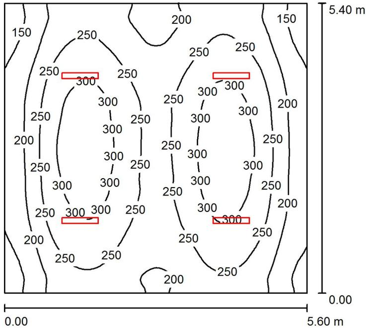
Altezza locale: 3.300 m, Altezza di montaggio: 3.000 m, Fattore di manutenzione: 0.80
