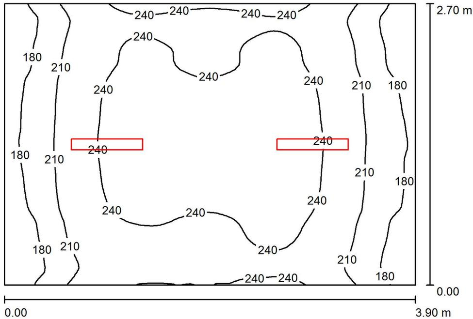
Altezza locale: 3.300 m, Altezza di montaggio: 3.000 m, Fattore di manutenzione: 0.80
