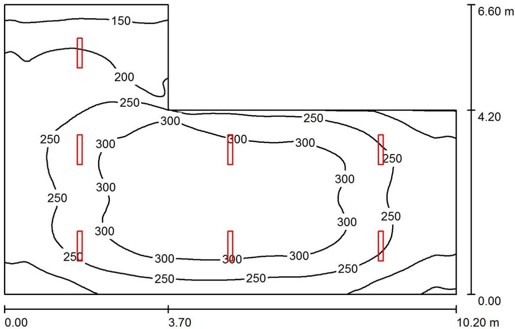
Altezza locale: 3.300 m, Altezza di montaggio: 3.300 m, Fattore di manutenzione: 0.80
