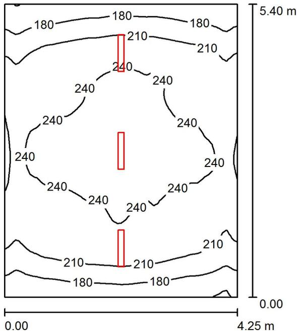
Altezza locale: 3.300 m, Altezza di montaggio: 3.000 m, Fattore di manutenzione: 0.80
