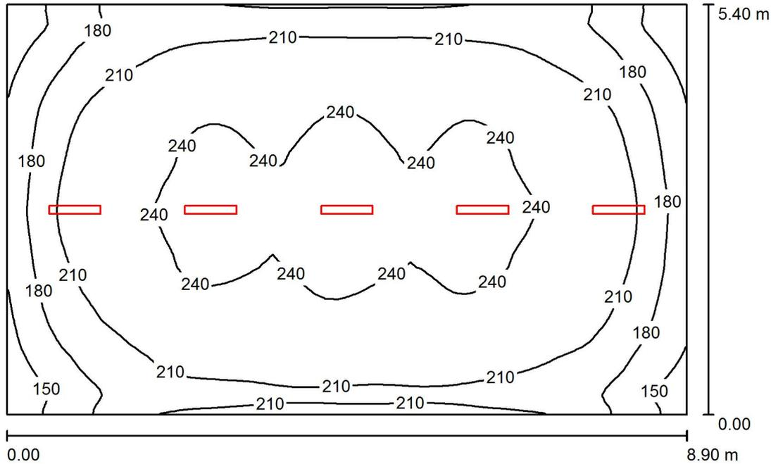
Altezza locale: 3.300 m, Altezza di montaggio: 3.000 m, Fattore di manutenzione: 0.80
