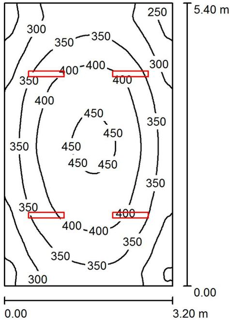
Altezza locale: 3.300 m, Altezza di montaggio: 3.000 m, Fattore di manutenzione: 0.80
