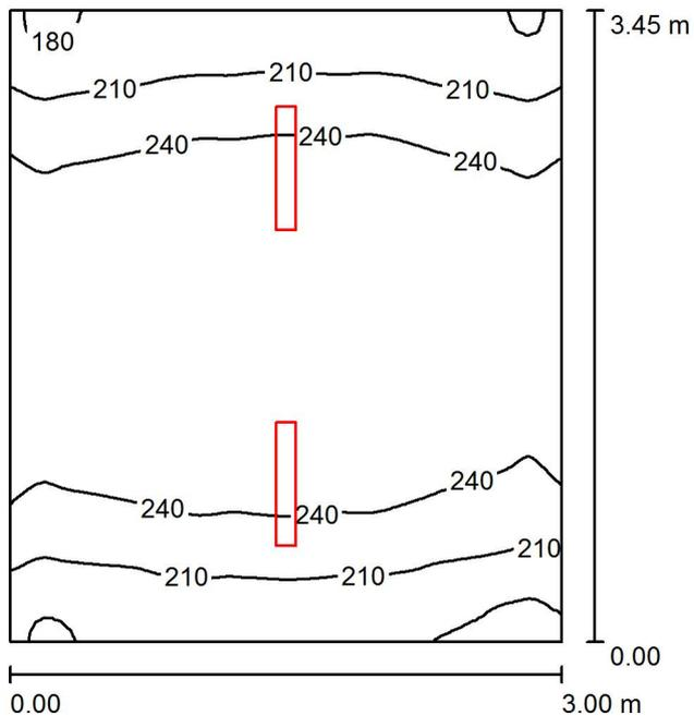
Altezza locale: 3.300 m, Altezza di montaggio: 3.000 m, Fattore di manutenzione: 0.80
