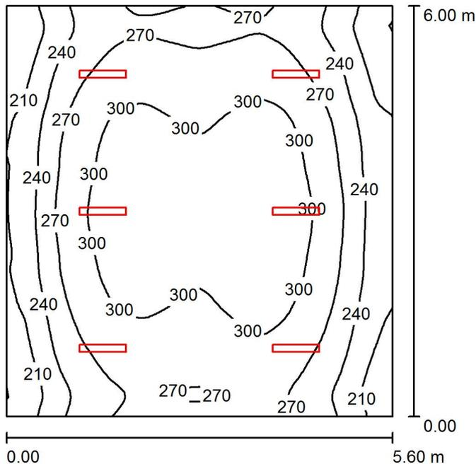
Altezza locale: 4.200 m, Altezza di montaggio: 4.200 m, Fattore di manutenzione: 0.80
