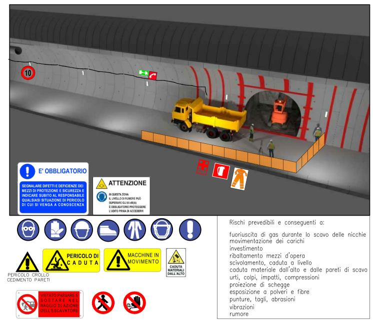
FASE 5 - POSA IN OPERA DEL RIVESTIMENTO DI PRIMA FASE SUCCESSIVA POSA IN OPERA DELL'IMPERMEABILIZZAZIONE
