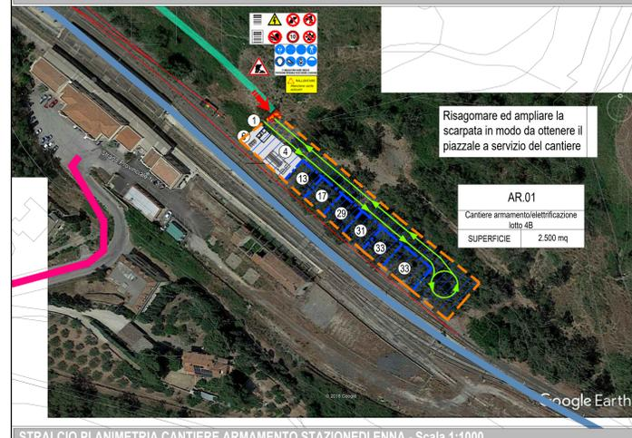
Risagomare ed ampliare la scarpata in modo da ottenere il piazzale a servizio del cantiere
