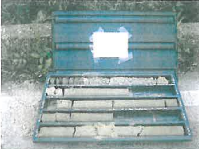
Foto 11 – Sondaggio PG5 Cassetta 1 (0-5 m)
