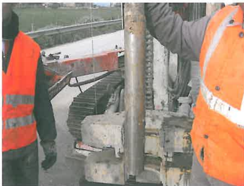
Fig.5 - Prelievo di campione indisturbato nel corso dei sondaggi
