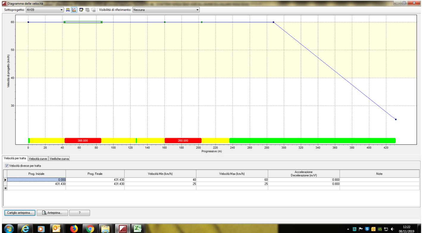
Sulla base di tale diagramma sono stati verificati gli elementi planimetrici ed altimetrici.
