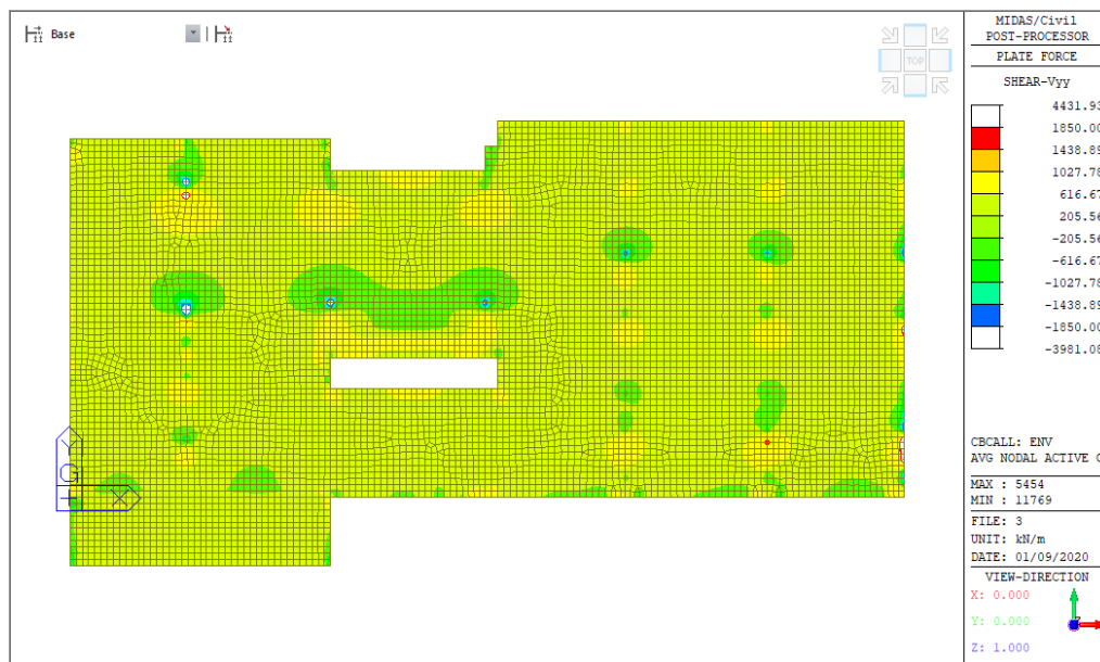
Figura 48 – Taglio resistente spilli \Phi 12/15 \times 30 \text{cm} V_{Rcd,yy}
