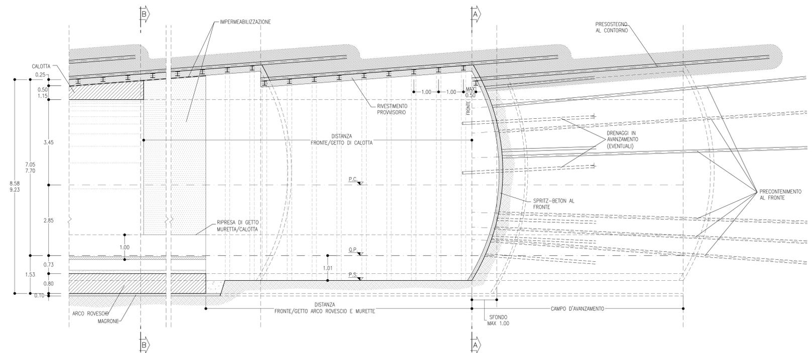
**FINESTRA CARRABILE SEZIONE TIPO B1**
