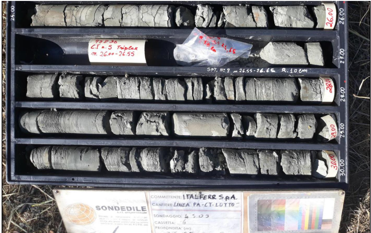
Figura 7 – Foto cassetta sondaggio 4SD3 (unità TRVa)
