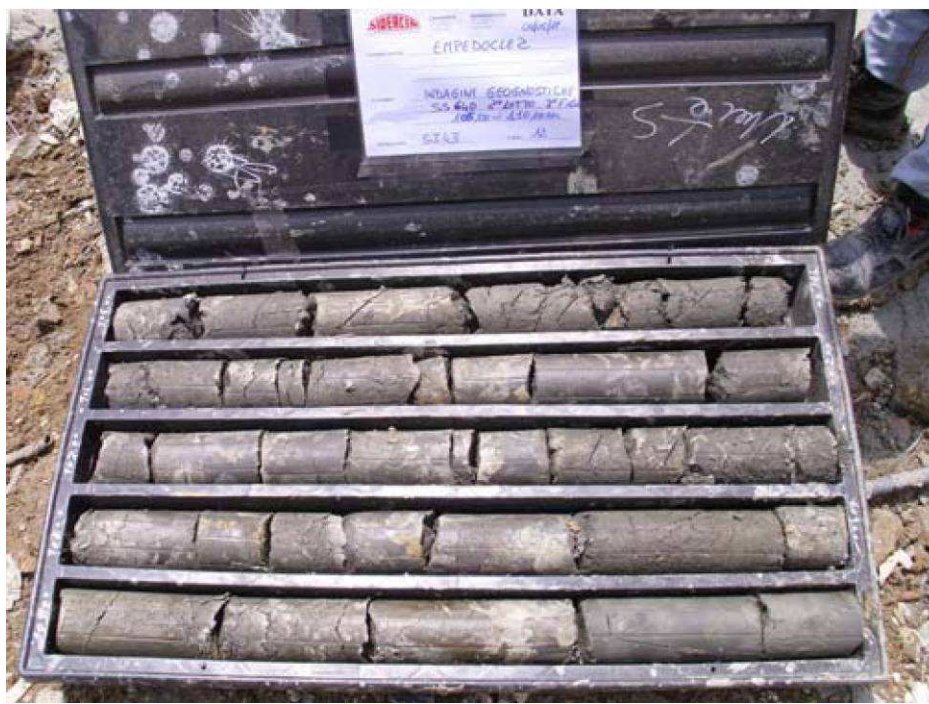
Fig. 11.6 – Cassetta delle carote prelevate da sondaggio SI43 da 105 a 110 m di prof.; si rileva una intensa fratturazione delle argille tortoniane coinvolte nella fascia tettonizzata del sovrascorrimento di tale formazione sulle formazioni plioceniche.
