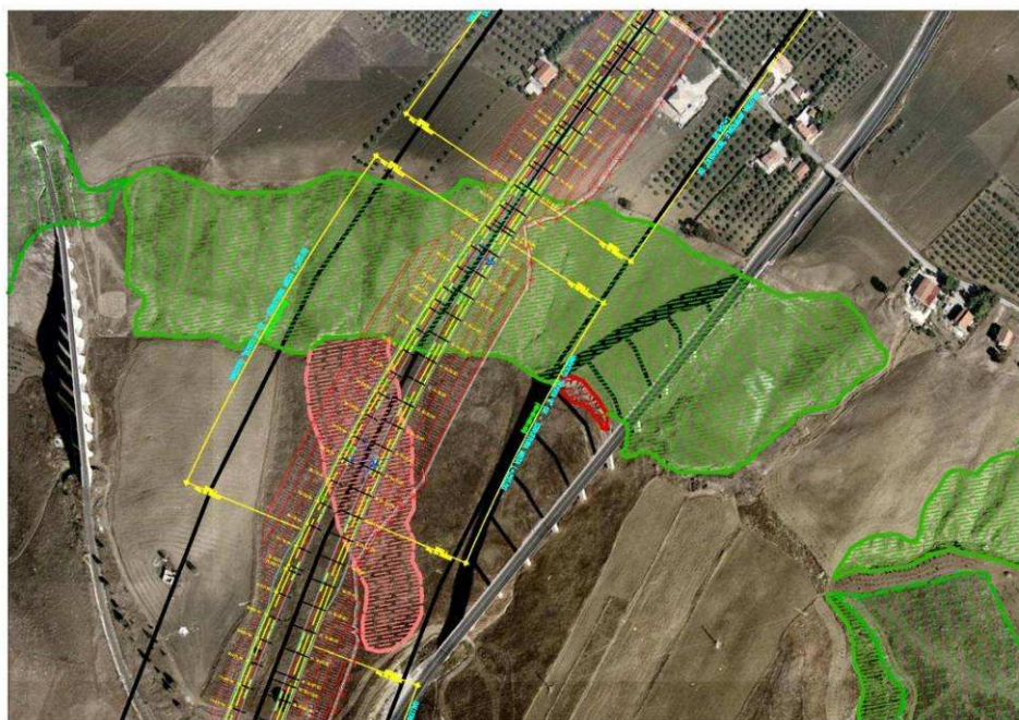
Figura 11 – Dissesti n°24 – 25 (Erosione diffusa, Scoscendimenti Sup.)
