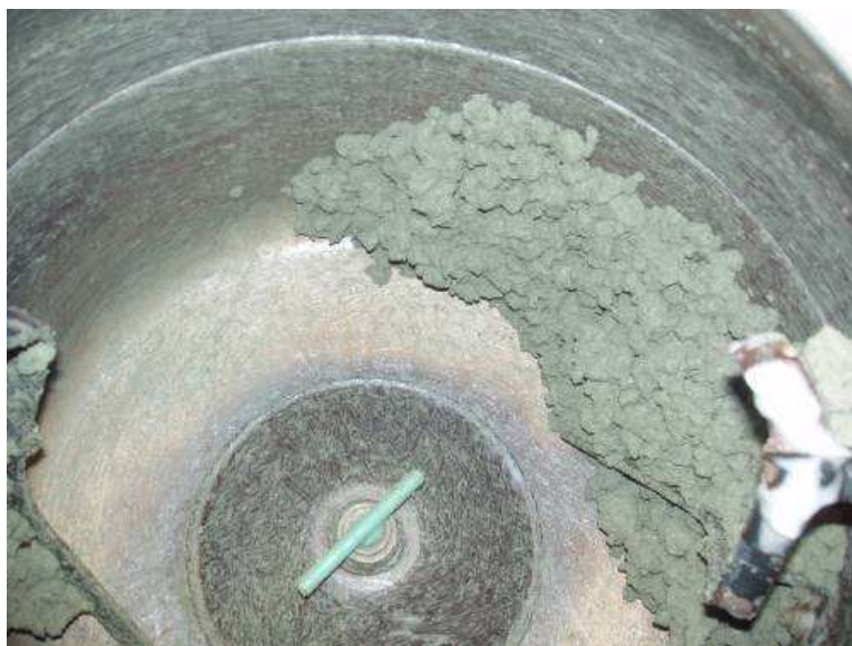
Fig. 11.3 – Interno della betoniera utilizzate nelle prove per la miscelazione in cui si osserva il comportamento coloso delle argille che si incollano alle pareti della stessa
