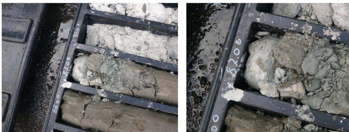
Fig. 11.2 – Particolare della carota (a dx ingrandimento) in cui avviene il passaggio tra i calcari e le argille brecciate a circa 87 m.
