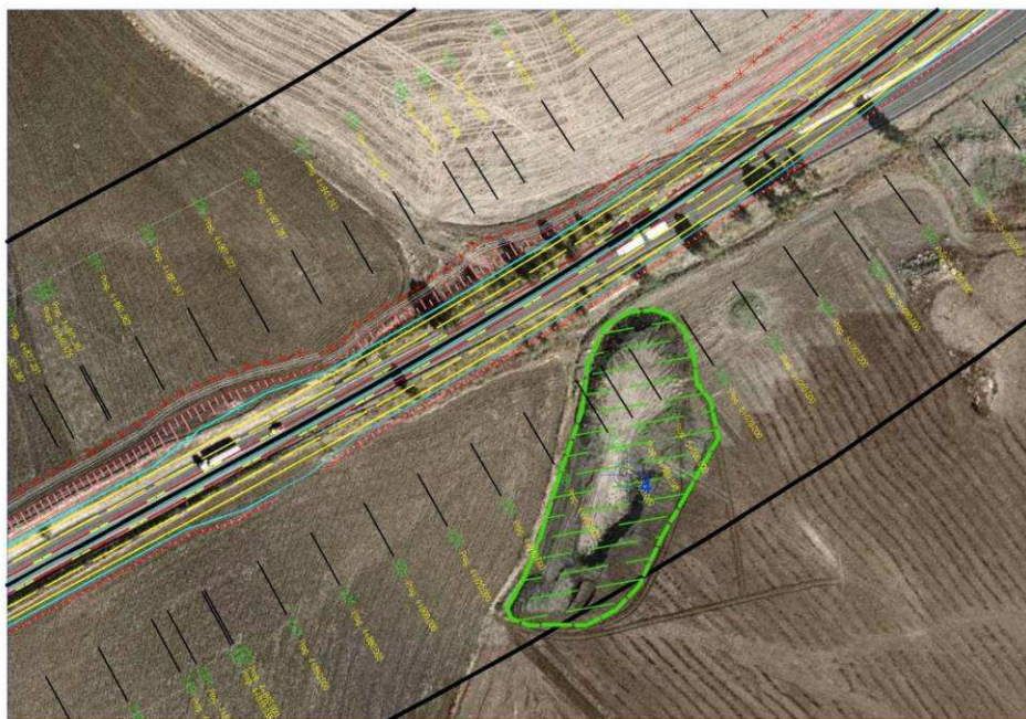
Figura 4 – Dissesto n°4 (Erosione diffusa)
