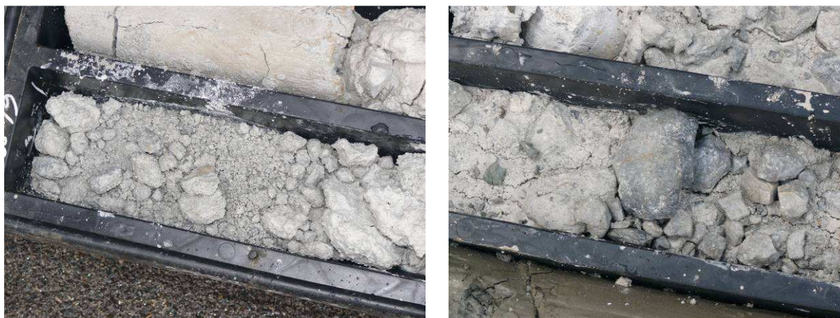
Fig. 11.1 – Confronto tra i calcari prelevati a circa 64 m (a sn) e a 86 m (a dx).
