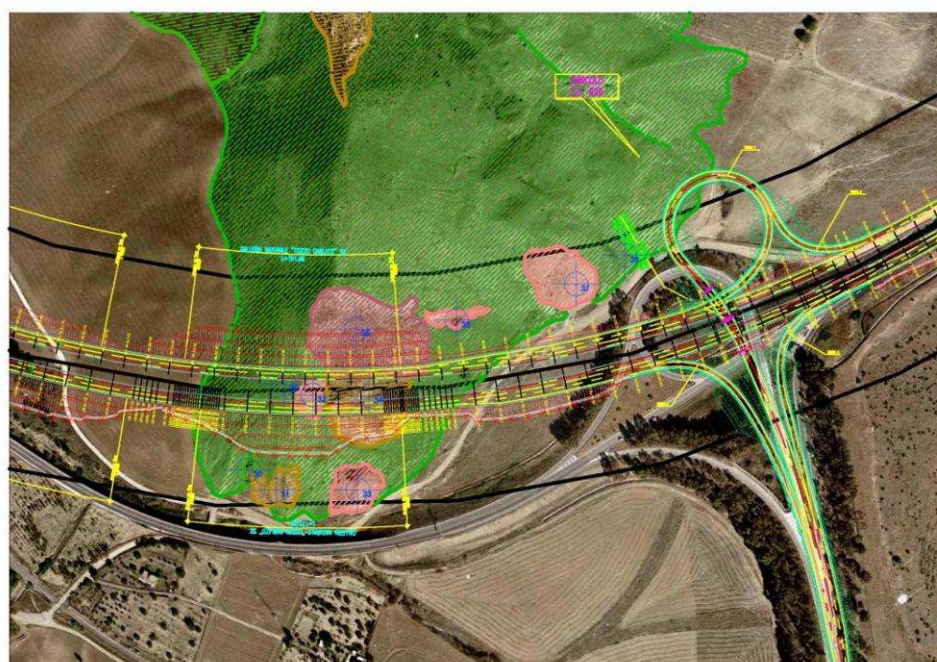
Figura 14 – Dissesti n° 29 – 38 (Calanchi, Scoscend . Sup., Erosione diffusa, Crolli, Complessa)
