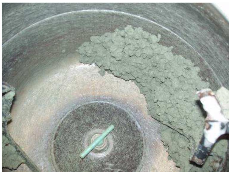
**Fig. 3.2 – Interno della betoniera utilizzate nelle prove per la miscelazione in cui si osserva il comportamento colloso delle argille che si incollano alle pareti della stessa**
