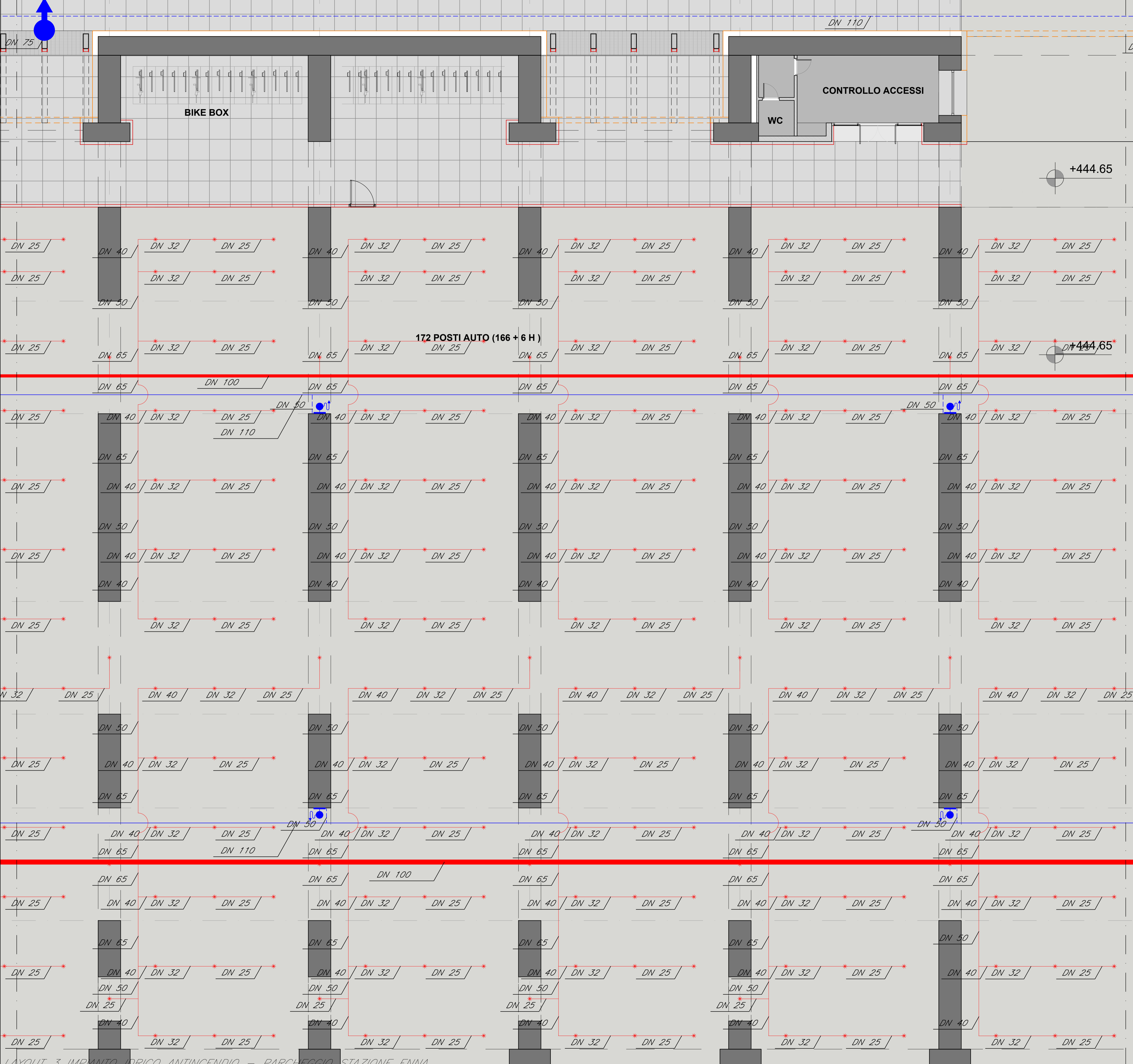
LAYOUT 3 IMPIANTO IDRICO ANTINCENDIO - PARCHEGGIO STAZIONE ENNA
