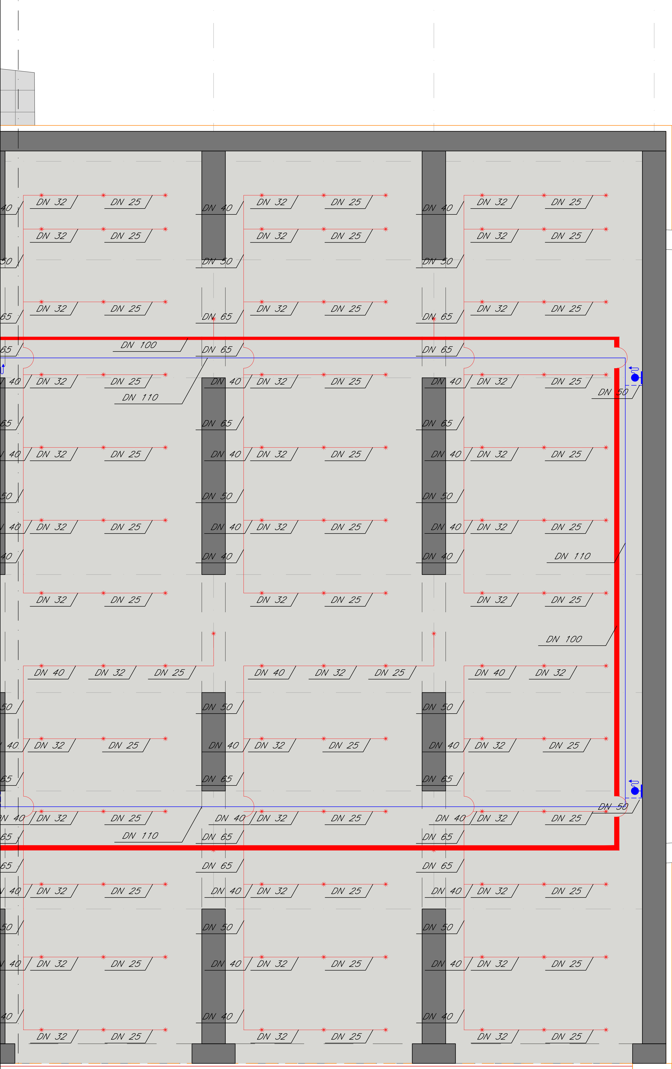
LAYOUT 5 IMPIANTO IDRICO ANTINCENDIO - PARCHEGGIO STAZIONE ENNA
