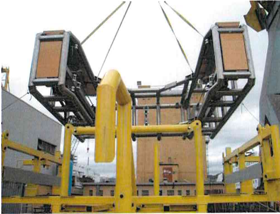
Figura 10-17 – Sistema di taglio DWCS per taglio a cavo diamantato - Tipico
