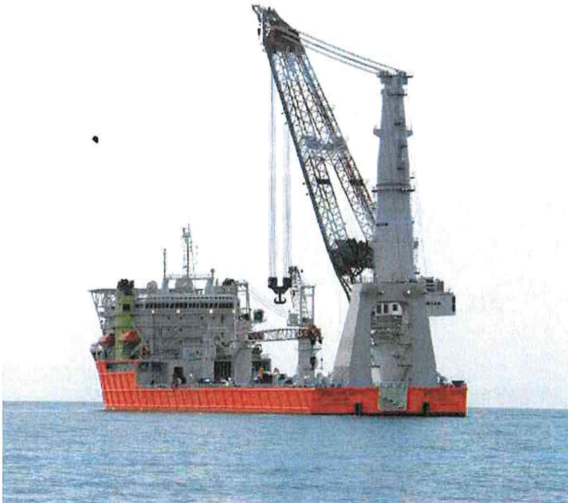
Figura 10-4 – Tipica Nave Gru con Gru a Braccio Mobile e Girevole
