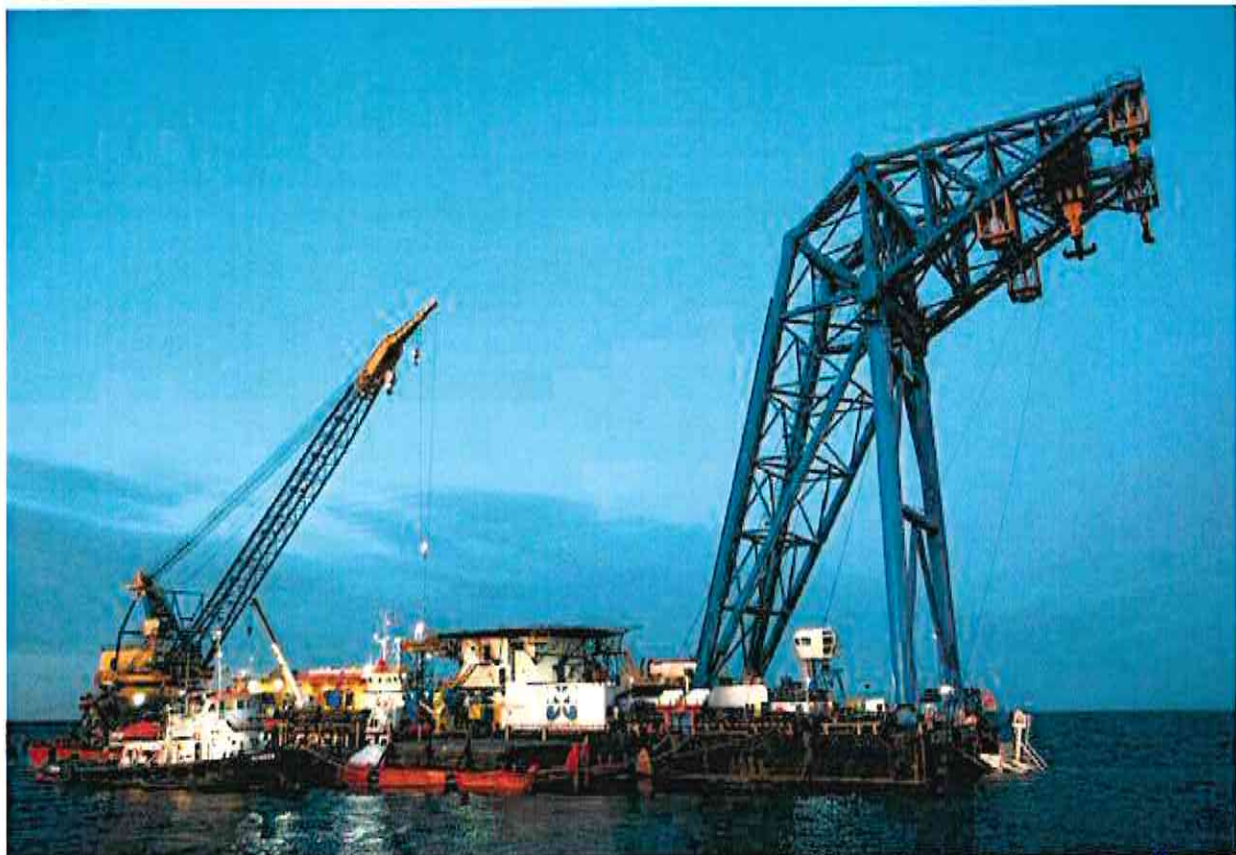
Figura 10-6 – Tipica Nave Gru con Gru a Braccio Fisso e con Booming
