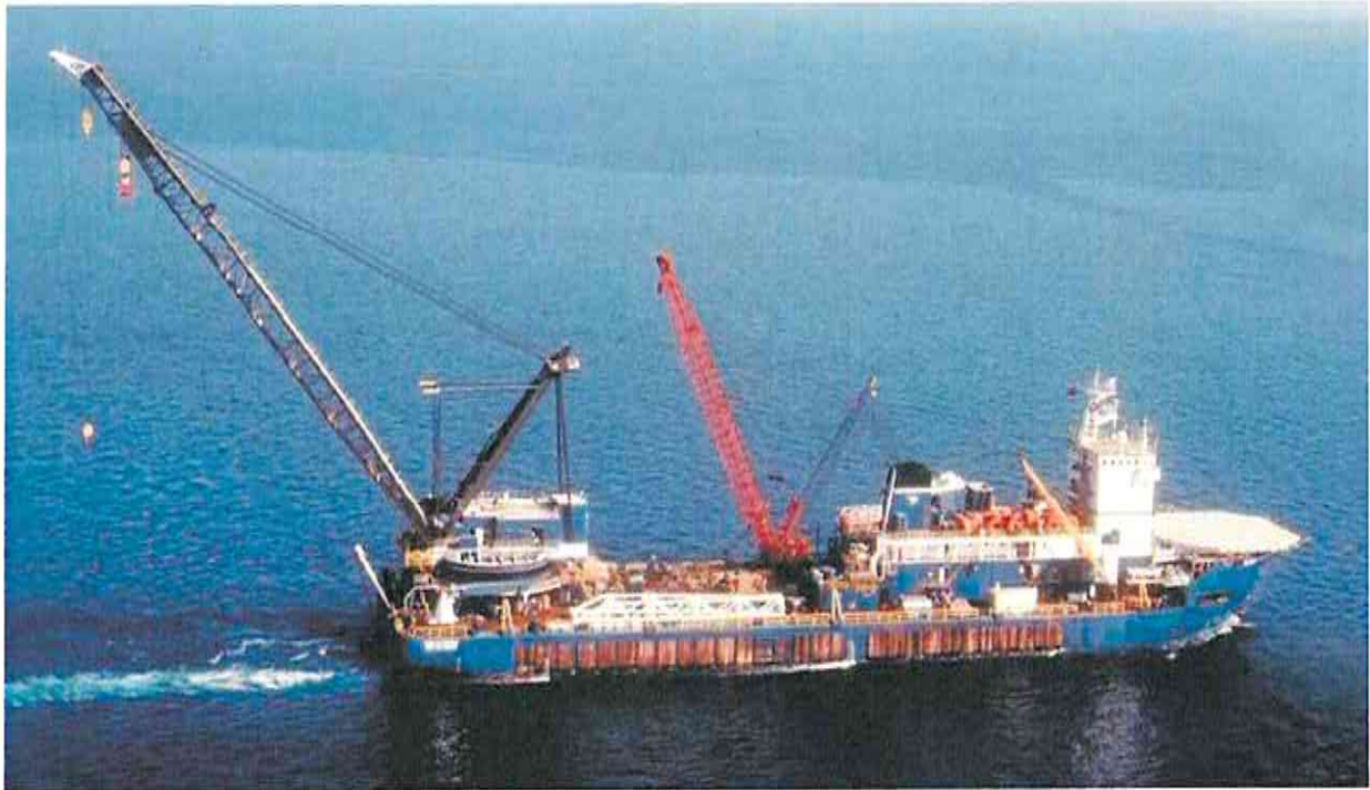
Figura 10-5 – Tipica Nave Gru con Gru a Braccio Mobile e Girevole
