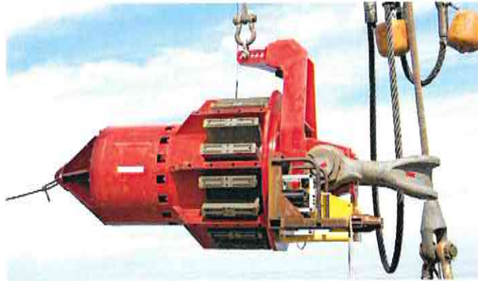
Figura 4-2 – Sistema di sollevamento ILT - Tipico
