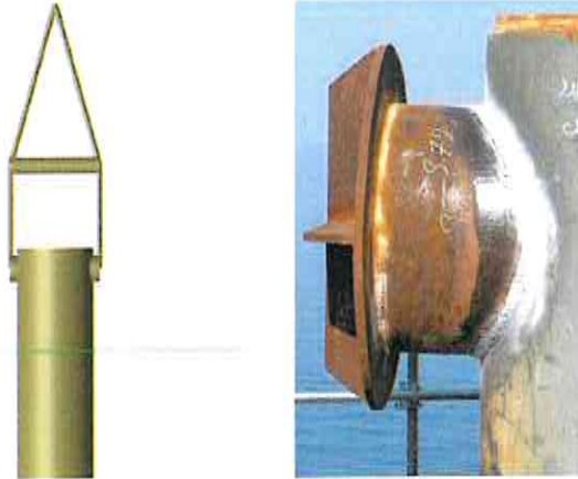
Figura 4-1 – Sistema di sollevamento con bitte – Tipico
