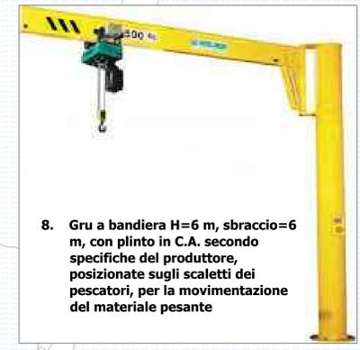
8. Gru a bandiera H=6 m, sbraccio=6 m, con plinto in C.A. secondo specifiche del produttore, posizionate sugli scaletti dei pescatori, per la movimentazione del materiale pesante
