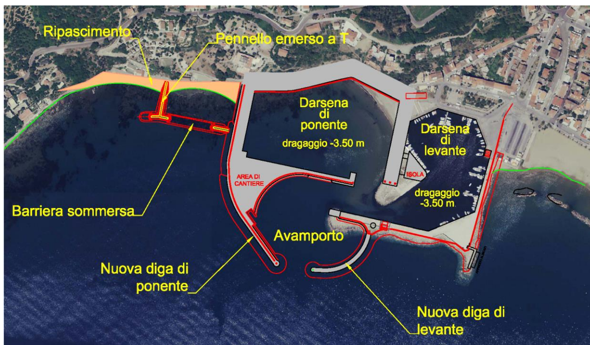
Figura 3 - Configurazione delle opere previste dal Progetto Preliminare redatto nel 2008.
