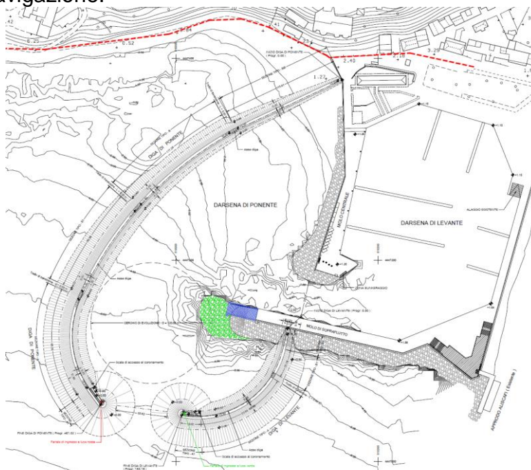
Soluzione A – Configurazione alternativa con radicamento diga di ponente alla radice dell'esistente molo di sottoflutto
