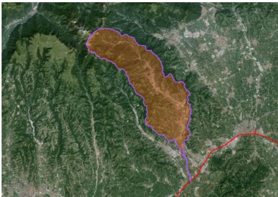
Figura 5-6 - Bacino Fiume Guà alla sezione di chiusura determinata dalla nuova linea AV/AC .
