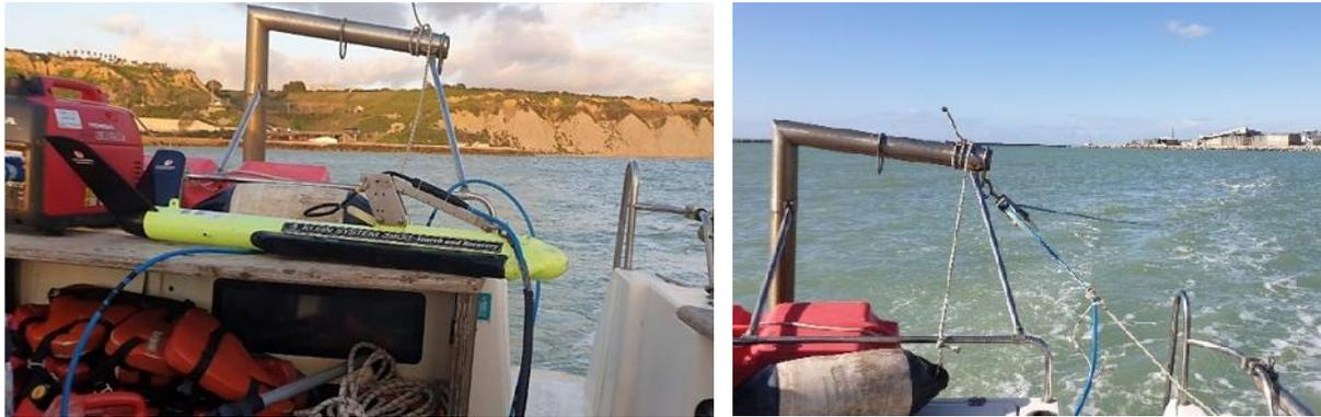
Figura 3.29 – Sistema SSS Klein 3900 impiegato per i rilievi.
