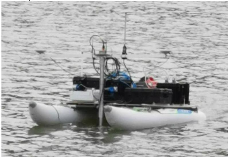
Figura 3.17 – Antenne GPS montate sull'imbarcazione durante il survey.
