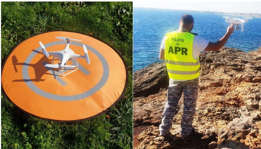
Figura 3.4 – Drone DJI Phantom 4 PRO V2 in fase di decollo. Tutte le operazioni sono state svolte da pilota certificato ENAC.
