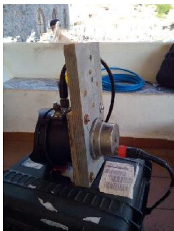
Figura 3.23 – Trasduttore installato insieme all'iMU sulla flangia del palo
