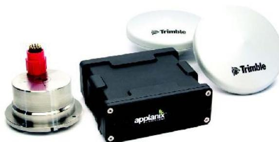
Figura 3.16 – Applanix POS-MV. Sistema integrato per la correzione dei movimenti di pitch, roll, heave heading e per il posizionamento di superficie (RTK).
