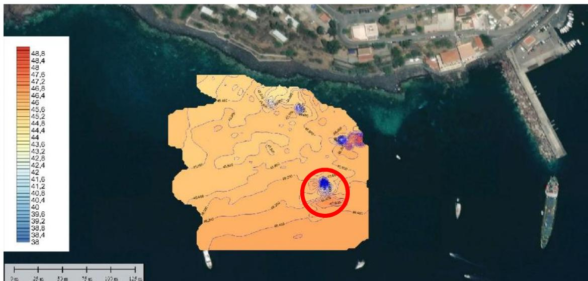
Figura 5.30 – Salina (ME): Restituzione grafica dell'indagine magnetometrica.
