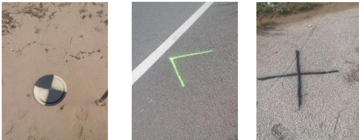
Figura 3.8 – Esempi di GCP utilizzati per la registrazione della posizione e della quota.
