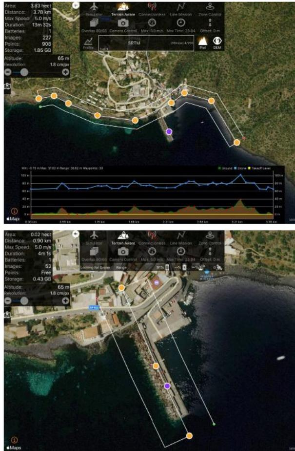
**Figura 3.6 – Pianificazione della missione di volo automatica legata al profilo derivato dal DSM. In tal modo il programma di comando e controllo crea una rotta lasciando che l'APR viaggi sempre alla stessa quota rispetto al terreno sottostante.**
