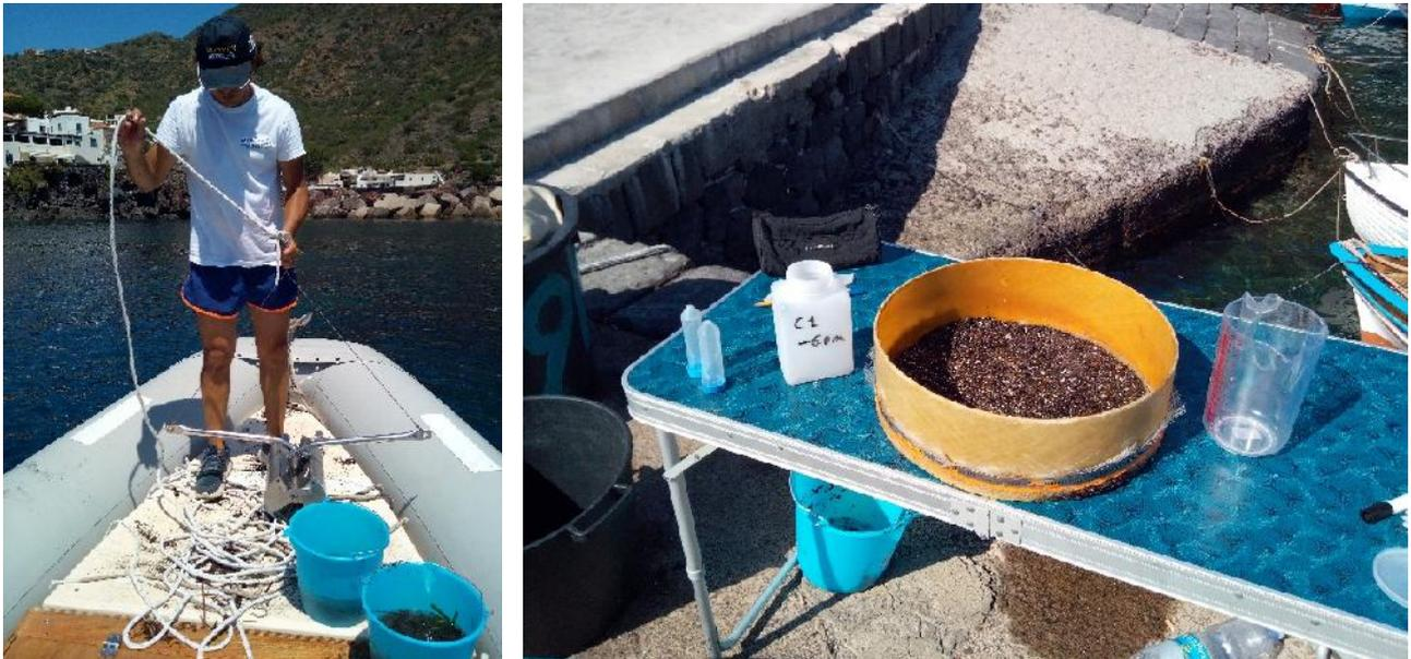
Figura 3.34 – Benna Van Veen da 25 l in fase di immersione (sinistra) e di apertura per recupero del campione prelevato (destra).
