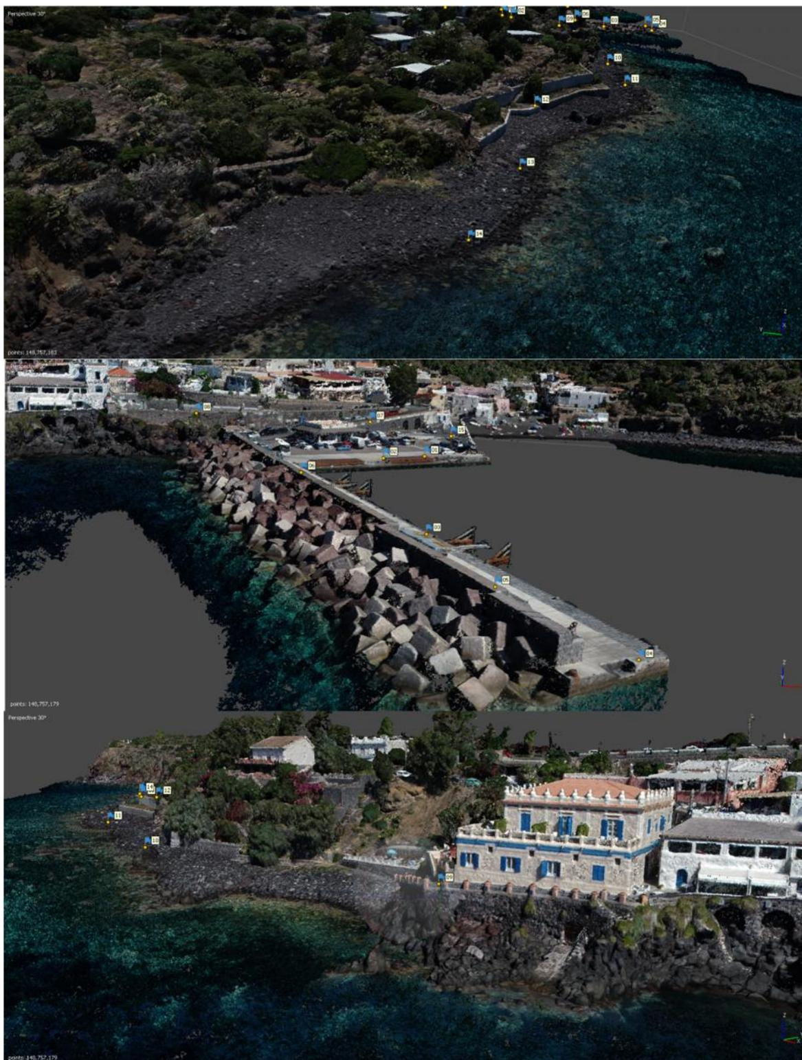
Figura 4.6 – generazione della nuvola di punti densa e colorata
