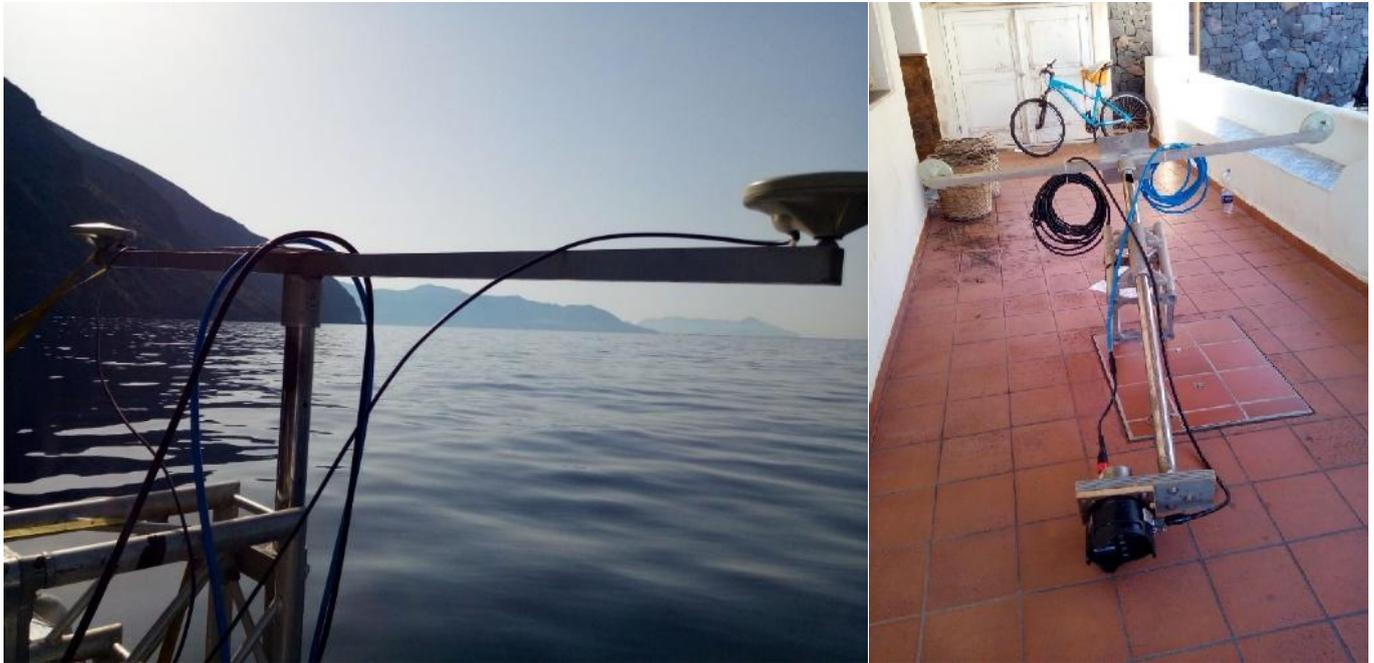
**Figura 3.24 – Installazioni strumentali esemplificative a bordo dell'imbarcazione "gomnone" impiegata nell'esecuzione del rilievo Mbes. Si noti in dettaglio il sistema di "Frame" realizzato e tarato ad hoc per l'installazione di tutti i sensori della piattaforma inerziale INS Applanix e del sistema Mbes M3 Kongberg**
