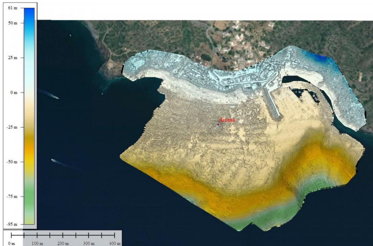
Figura 5.15 – Salina (ME): modello di elevazione digitale (DEM) generato dalla elaborazione dei dati batimetrici (maglia di acquisizione maglia 0,25x0,25 m e riportato su GIS insieme all'ortofoto dell'area di
