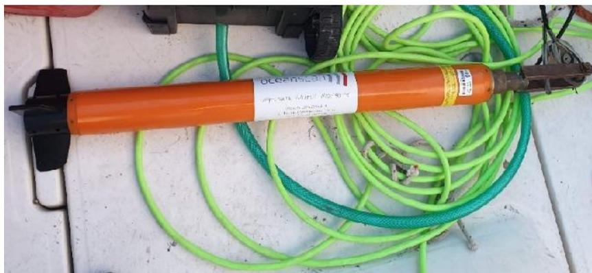
Figura 3.33 – SeaSpy Marine utilizzato per i rilievi, particolare del towfish e del cavo di traino e trasferimento dati.
