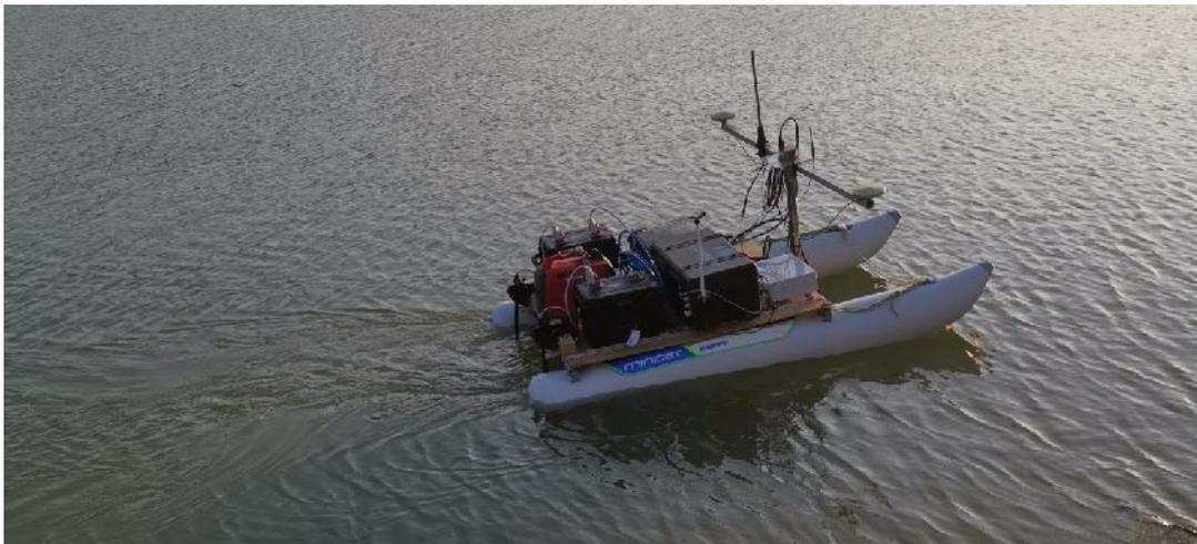
**Figura 3.2 – ASV Geodrone configurato per l'esecuzione del rilievo Mbes**
