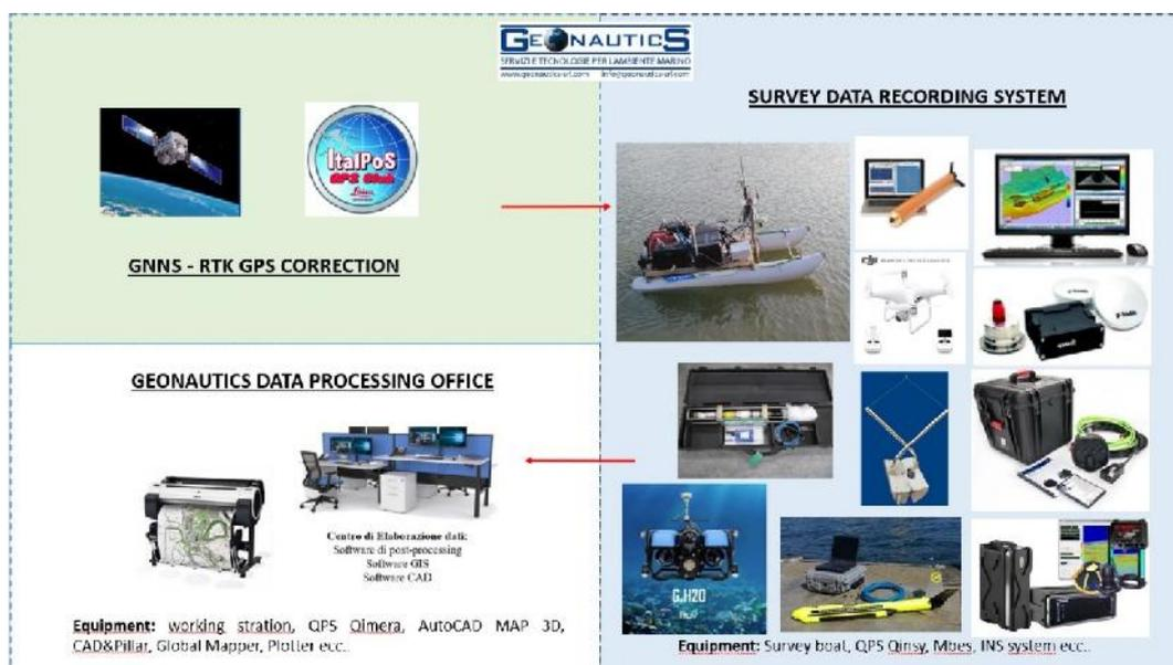
Figura 3.15 – Schema generale che mostra la configurazione strumentale, le installazioni e le fasi di lavoro impiegate per l'esecuzione dei rilievi batimetrici.
