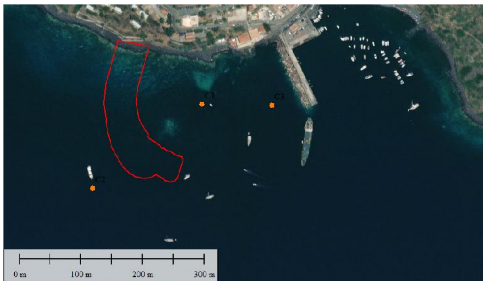
Figura 3.2– Area di studio; Impronta progettuale del molo e stazioni di campionamento dei sedimenti e delle comunità bentoniche di fondo mobile
