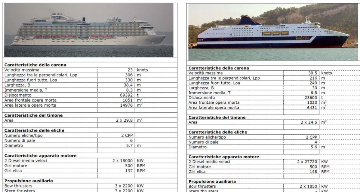
Figura 13. A sx: Caratteristiche principali della nave Cruise; A dx: Caratteristiche principali della nave ro-pax
