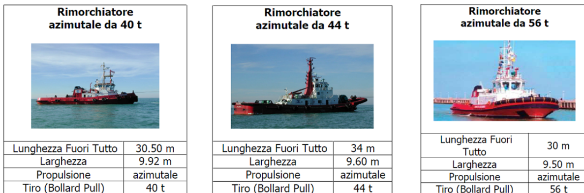
Figura 14. Rimorchiatori a propulsione azimutale in uso nel Porto di Fiumicino
