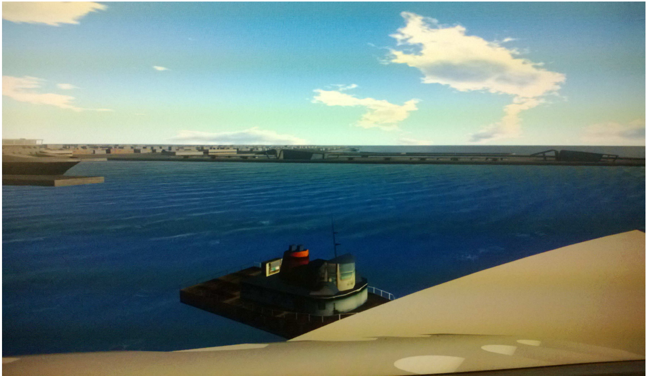
Figura 4 - Simulatore SAND – Vista da prora dello scenario in 3D, con nave da crociera in prossimità della banchina di arrivo con rimorchiatore in ausilio a spingere
