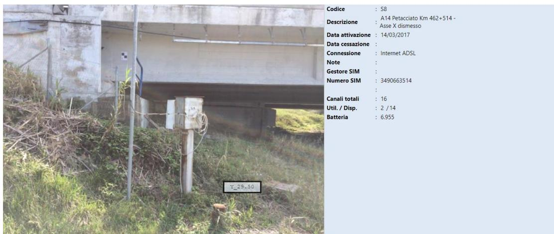
Figura 1: Inclinometro fisso (29.5m) a lettura automatica in posizione sondaggio S8
