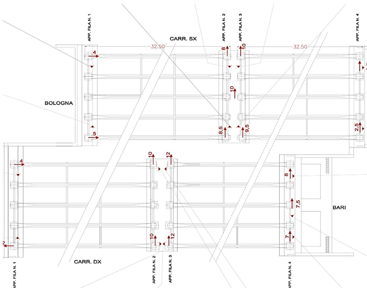
Figura 17: Viadotto Cacchione – Letture manuali dei trasduttori di movimento a seguito dell'evento del 2009
