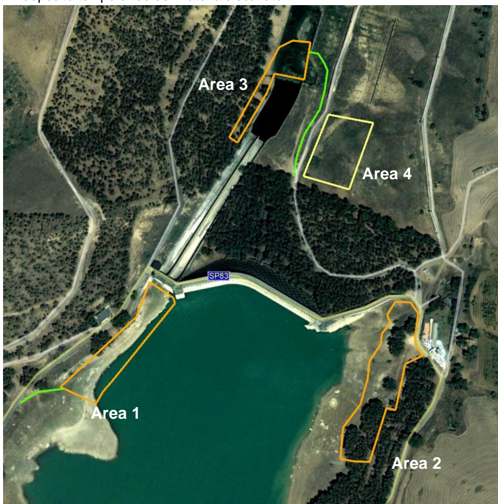
Figura 2-29. Organizzazione delle aree di cantiere
