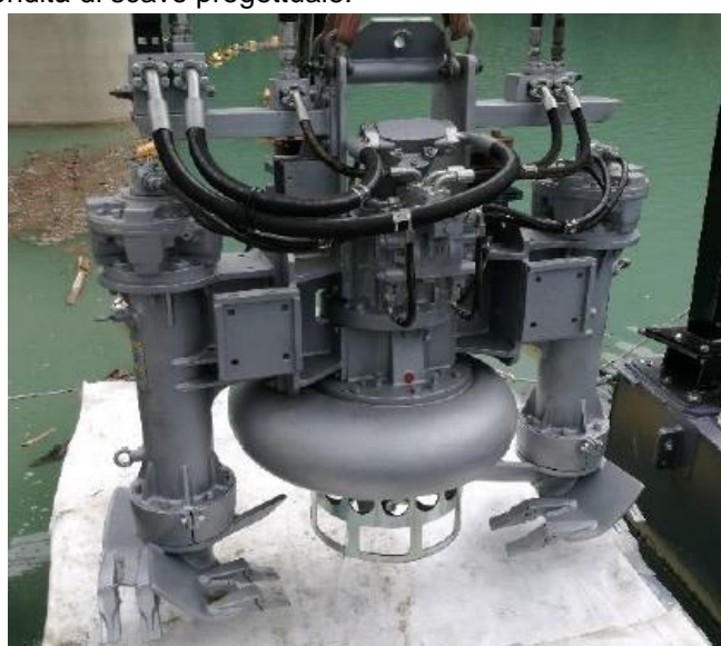
Figura 2-37. Esempio di pompa idraulica sommergibile
