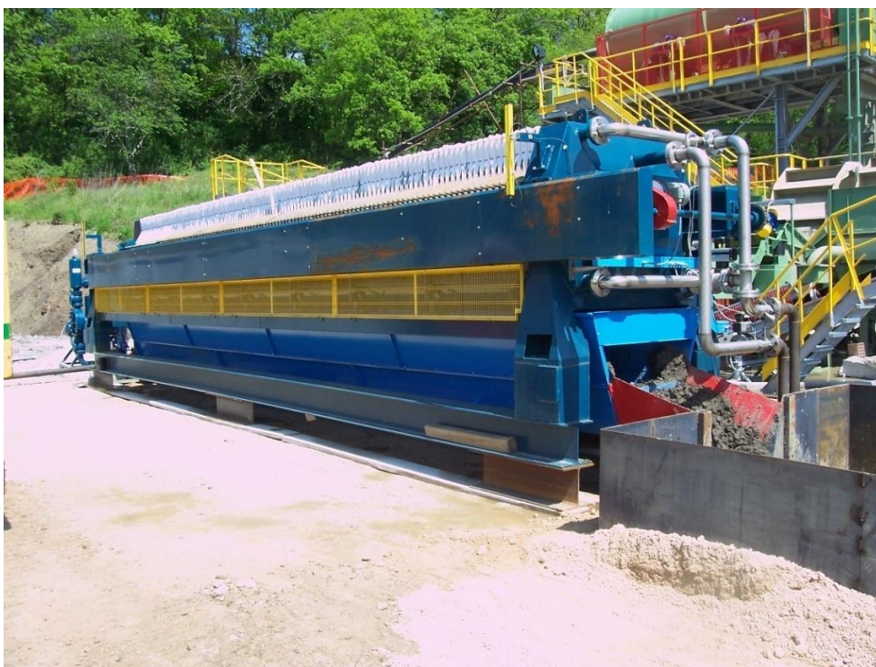
Figura 2-43. Esempio di filtropressa
